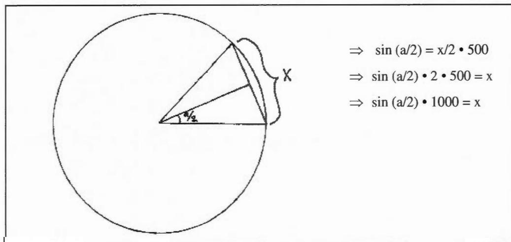
Figure 3.27 : Formule pour déterminer la longueur d'une corde
