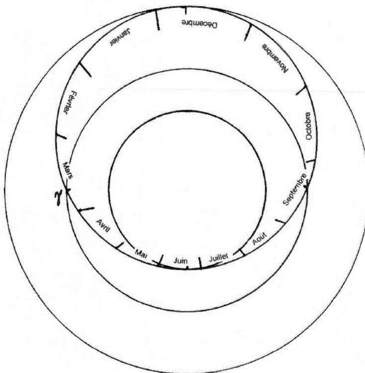
Figure 4.76 : Araignée de l'astrolabe – écliptique – 2
