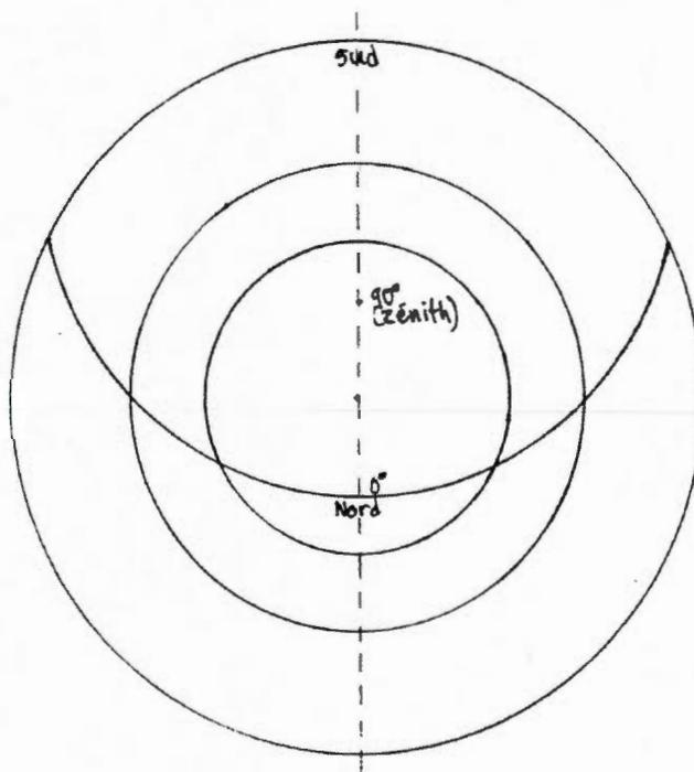
Figure 4.70 : Tympan de l'astrolabe – almucantarats –  $0^\circ$  et  $90^\circ$
