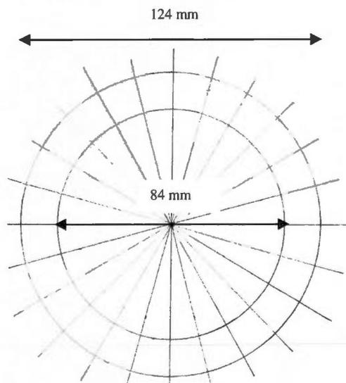
Figure 4.49 : Colure des équinoxes de la sphère armillaire – 1
