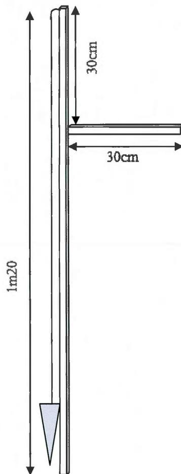
Figure 4.30 : Bâton de Gerbert – schéma
