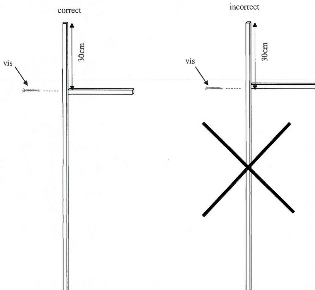
Figure 4.32 : Bâton de Gerbert – construction – 1
