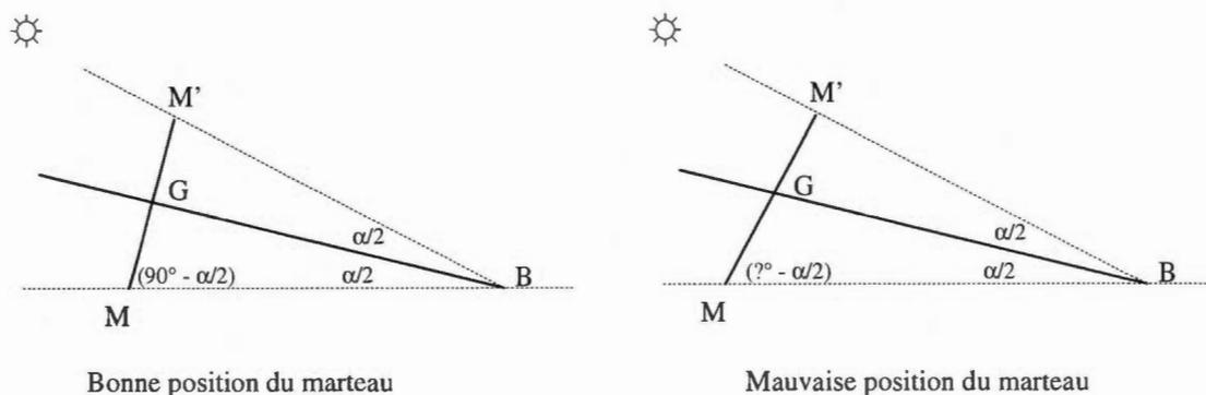
Figure 3.55 : Bâton de Jacob – mauvaise position du marteau
