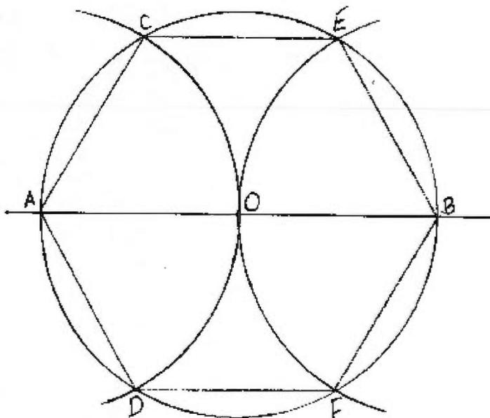
Figure 3.23 : Construction d'un hexagone
