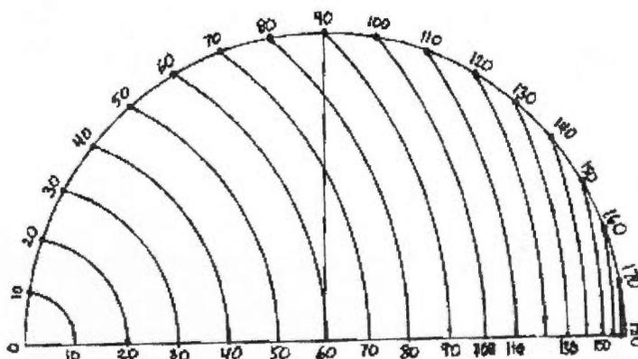
Figure 3.25 : Ligne des cordes – traçage des graduations
