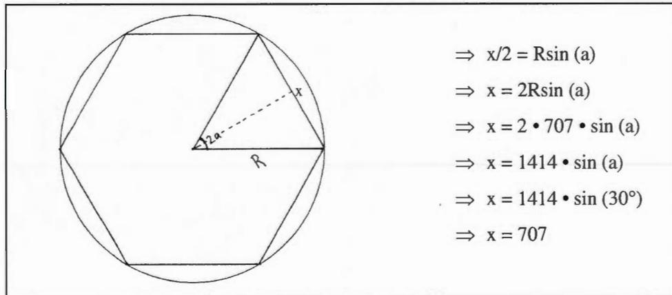
Figure 3.20 : Ligne des polygones – calcul de la longueur des côtés
