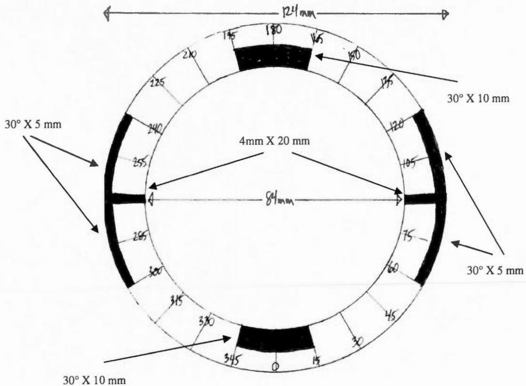
Figure 4.54 : Écliptique de la sphère armillaire – 2
