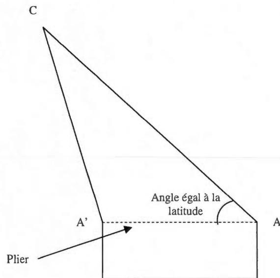
Figure 4.90 : Style pour le cadran solaire
