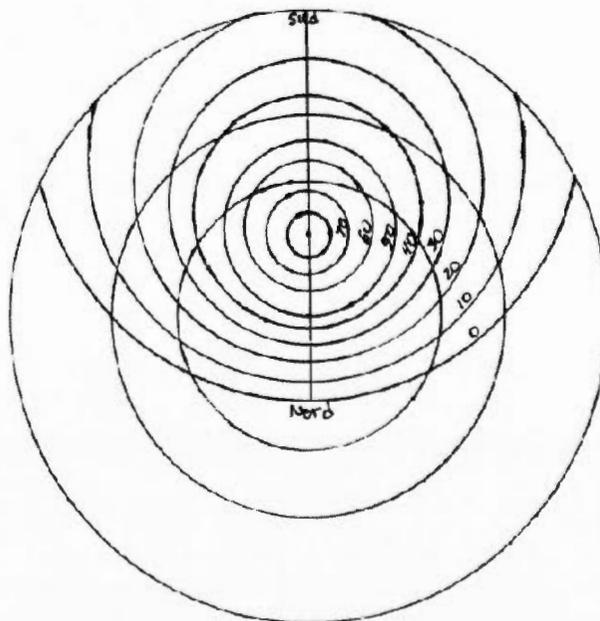
Figure 4.72 : Tympan de l'astrolabe – almucantarats – les autres degrés
