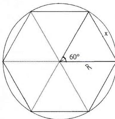
Figure 3.22 : Longueur du côté d'un hexagone
