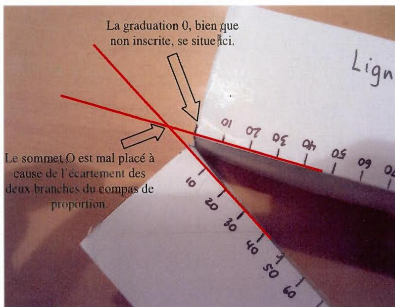
Figure 3.14 : Compas de proportion – mauvaise position du sommet O
