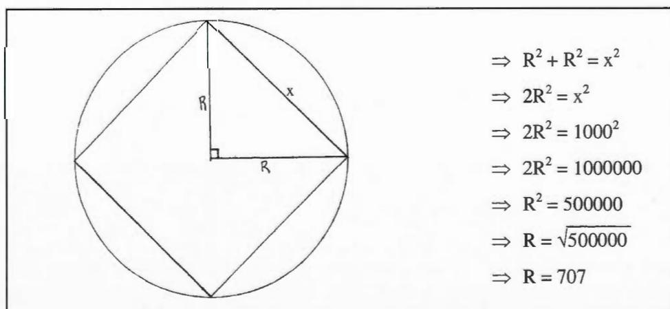
Figure 3.19 : Ligne des polygones – calcul du rayon
