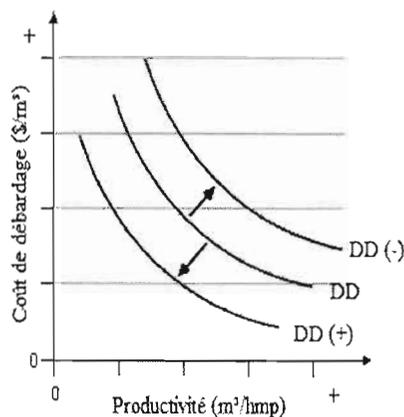
**Figure 1.6** Variation des coûts de débardage (\$/m<sup>3</sup>) en fonction de la productivité<sup>5</sup> (m<sup>3</sup>/hmp). DD(-) indique une diminution de la distance de débardage et DD(+) indique une augmentation de celle-ci.
