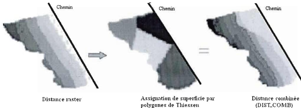
**Figure 1.14** Représentation graphique d'estimation de la distance de débardage moyenne combinée (DIST\_COMB) par l'intégration de la distance de débardage raster (DIST\_C) et l'assignation du volume par la méthode des polygones de Thiessen.
