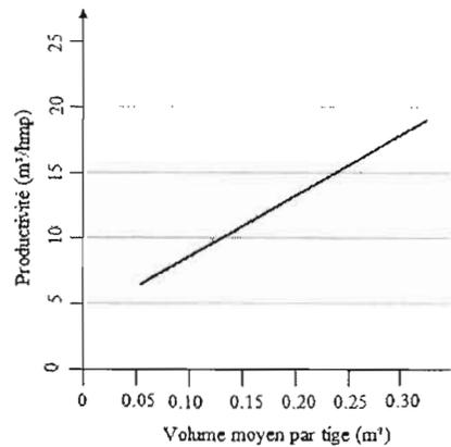
Figure 1.7 Productivité d'une abatteuse-façonneuse ( $\text{m}^3/\text{hmp}$ ) en fonction du volume moyen par tige<sup>6</sup> ( $\text{m}^3$ ).
