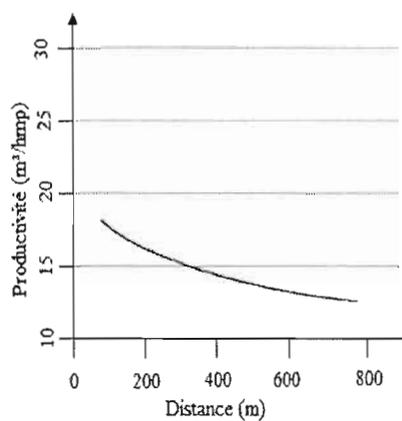
**Figure 1.5** Productivité du porteur ( $\text{m}^3/\text{hmp}$ ) en fonction de la distance de débardage<sup>4</sup> (m).
