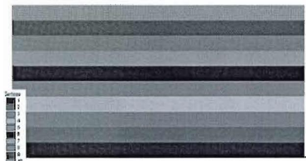
**Figure A.1.1** Bloc de taille moyen (62 ha), 500 m de profondeur et subdivisé dans 10 sections de 50 m.
