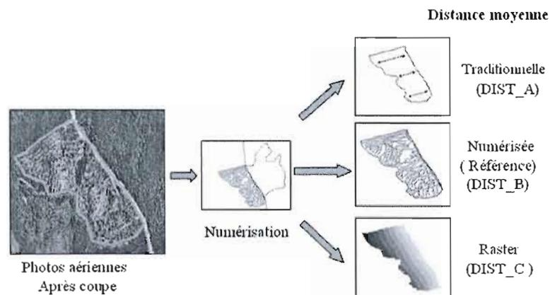
**Figure 1.11** Représentation graphique des méthodes d'estimation de la distance de débardage moyenne : (a) traditionnelle (DIST\_A), (b) numérisée ou référence (DIST\_B) et (c) raster (DIST\_C).
