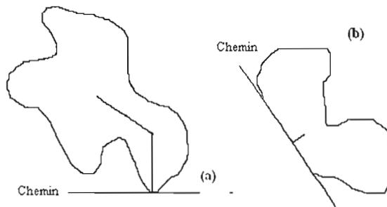
**Figure 1.2** Distance de débardage moyenne (m) estimée dans les blocs de récolte de forme géométrique irrégulière et débardage en bordure de la route. (a) et (b) exemples de blocs de forme irrégulière.
