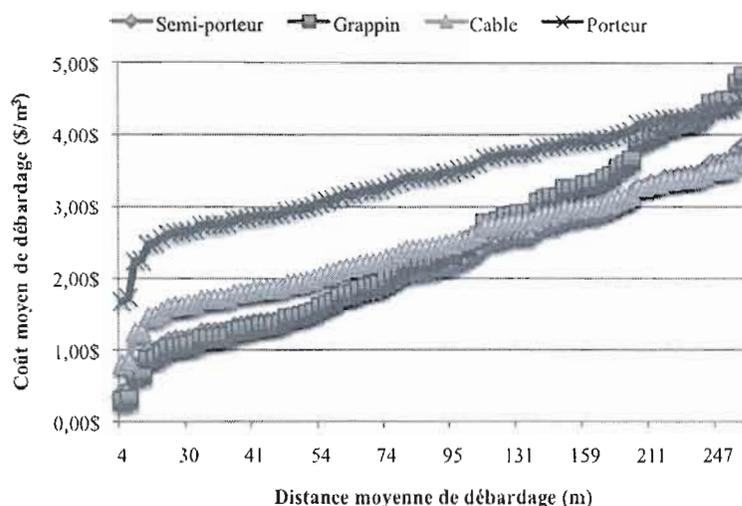
**Figure 1.31** Coûts moyens de débarquement ( $\$/m^3$ ) selon le type de machine de débarquement utilisé : Semi-porteur, Grappin, Câble et Porteur ; distance de débarquement DIST\_C.
