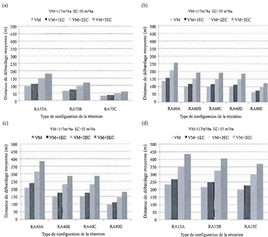
**Figure A.1.5** Distance moyenne de débardage combinée en fonction du volume à extraire : VM, VM+1EC, VM+ 2EC et VM+3EC (volume moyen et volume moyen plus un, deux et trois écarts-type) et types de configuration de la rétention : (a) RA75A, RA75B et RA75C, (b) RA60A, RA60B, RA60C, RA60D et RA60E, (c) RA40A, RA40B, RA40C et RA40D et (d) RA15A, RA15B et RA15C. (RA) rétention agglomérée, (75, 60, 40 et 15) pourcentages de rétention et (A, B, C, D ou E) configurations de la rétention.
