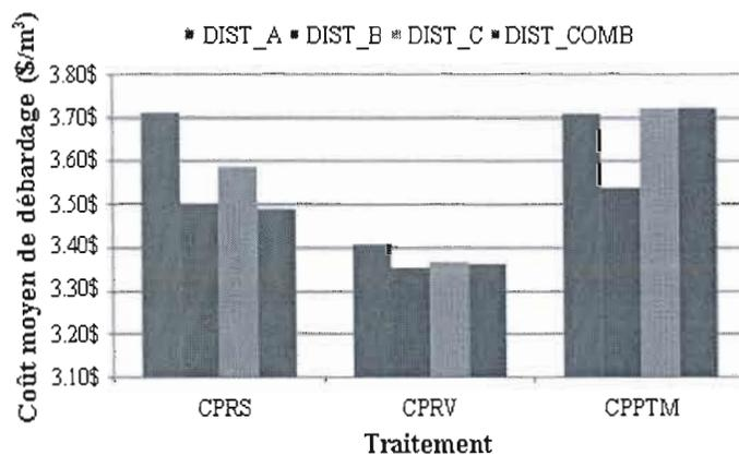
**Figure 1.29** Coûts moyens de débardage (\$/m<sup>3</sup>) estimés par distance de débardage : DIST\_A, DIST\_B, DIST\_C et DIST\_COMB pour un porteur.
