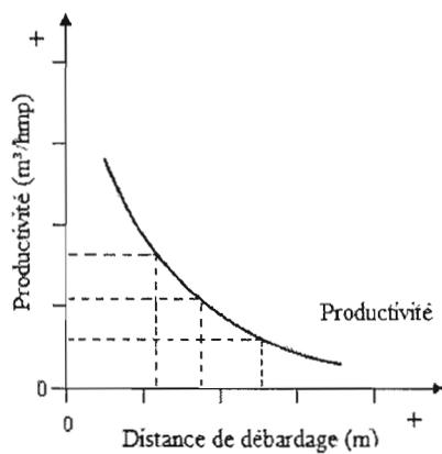
**Figure 1.4** Courbe de productivité des opérations de récolte forestière ( $\text{m}^3/\text{hmp}$ ) en fonction de la distance de débardage<sup>3</sup> (m).
