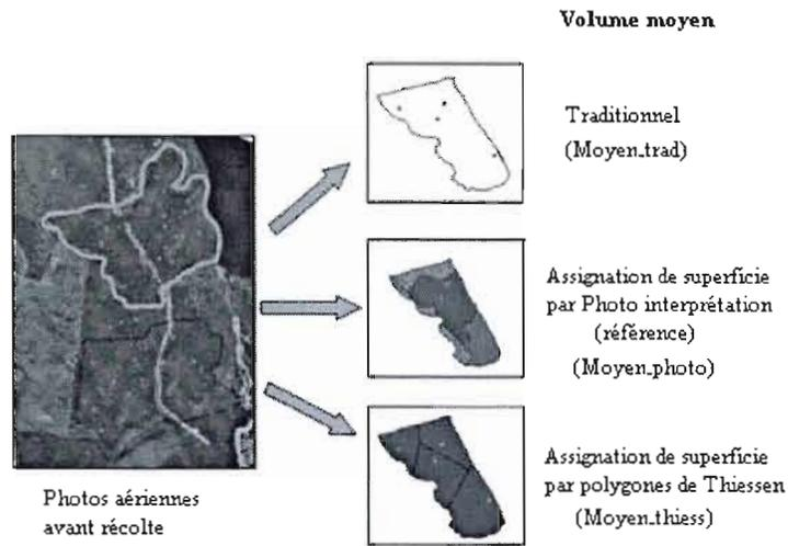
**Figure 1.13** Représentation graphique des méthodes d'estimation du volume moyen à l'hectare : (a) traditionnelle (Moyen\_trad), (b) par photo-interprétation (Moyen\_photo) et (c) par polygones de Thiessen (Moyen\_thiess).
