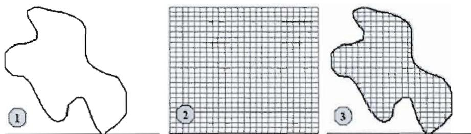
**Figure 1.3** Distance de débardage moyenne (m) estimée dans les blocs de récolte de forme irrégulière, par combinaison format raster-centroïde et débardage en bordure de la route. (1) bloc de forme irrégulière, (2) représentation de la distance raster à partir de la route et (3) combinaison de (1) et (2) pour le calcul de la distance moyenne de débardage.
