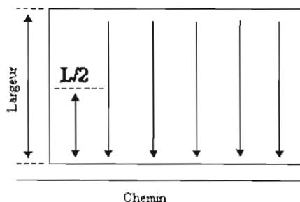
**Figure 1.1** Distance de débardage moyenne ( $L/2$ ) estimée dans les blocs de récolte de forme géométrique régulière et débardage en bordure de la route.
