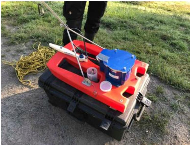
**Figure 23 : Vélocimètre Doppler intégrateur installé sur un flotteur.**
