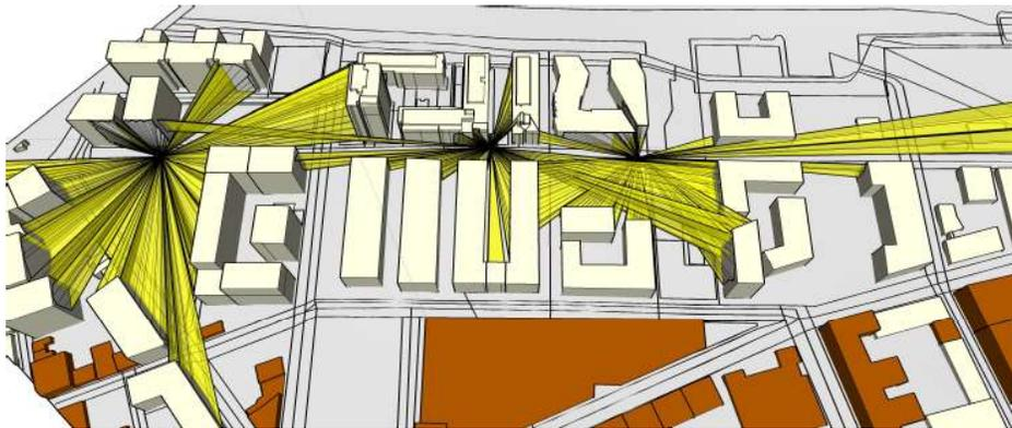
Figure 4.39 Analyse isovists 3D, montrant la limitation du champ de vision sur la rue des Bassins
