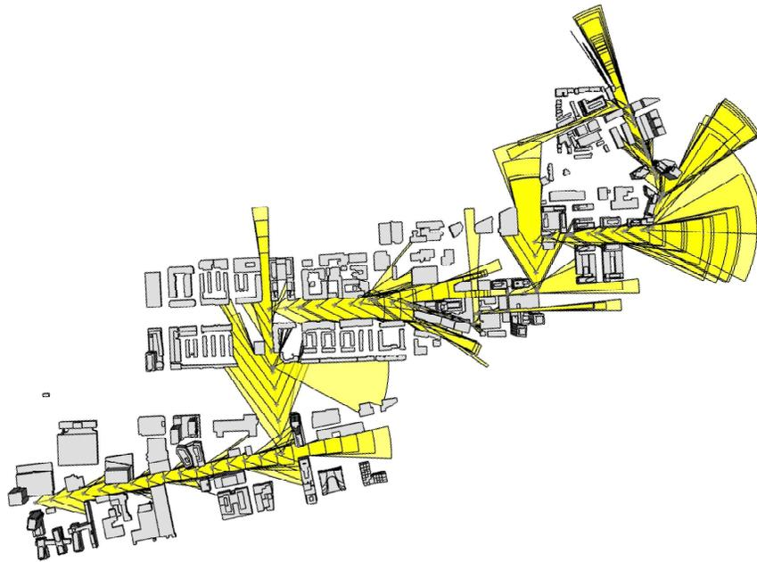
Figure 4.78 Séquence isovist 2D montrant un trajet potentiel de marche reliant les deux projets dans le secteur étendu à Toronto simulant les variations du champ de vision et les percées visuelles
