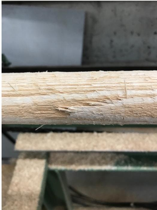
Figure 3.49 Éclatement fibre frêne : Prototype 3
