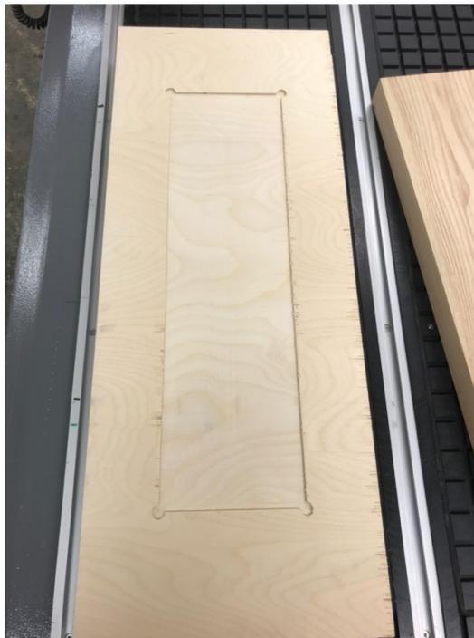
Figure 3.93 Gabarit usinage dossier commande numérique : Chaise finale
