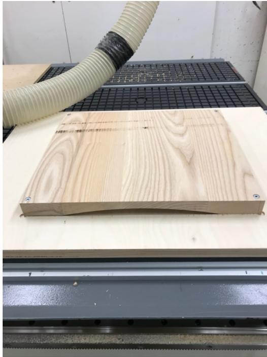
Figure 3.96 Usinage assise face convexe commande numérique : Chaise finale
