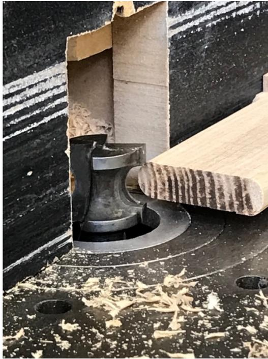
Figure 3.57 Usinage arrondie de tenon : Chaise finale
