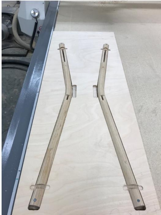
Figure 3.32 Gabarit usinage patte arrière : Prototype 3
