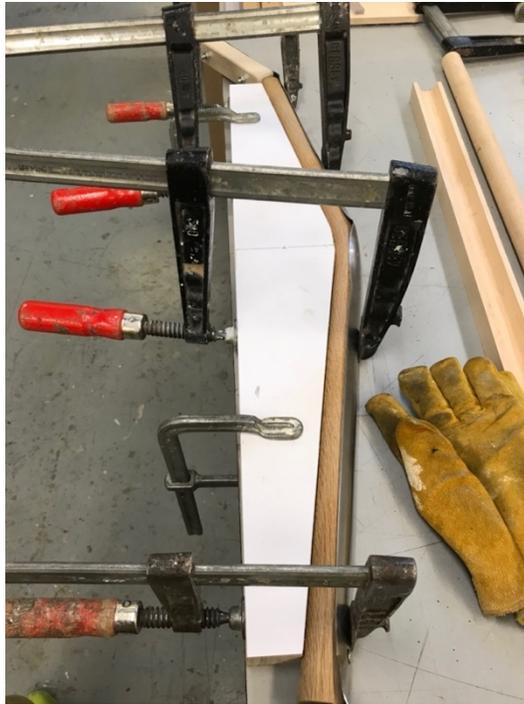
Figure 3.47 Cintrage chêne : Prototype 3
