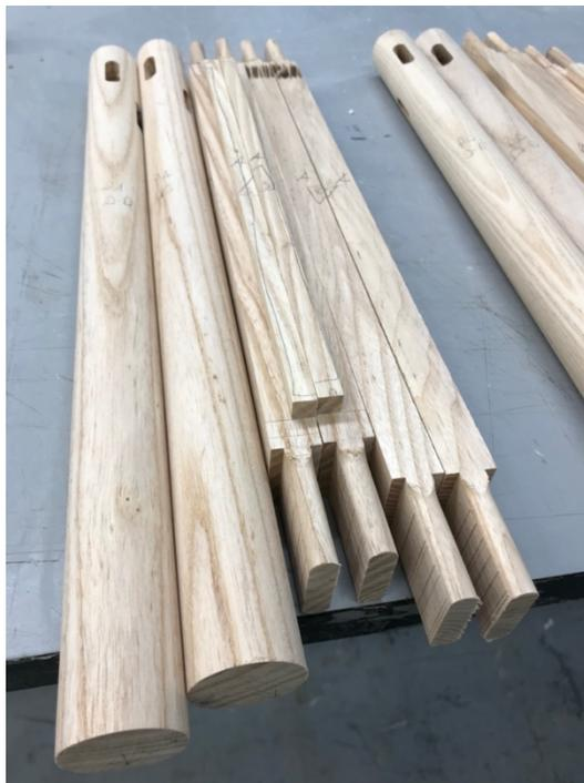
Figure 3.58 Ajustement pattes traverse : Chaise finale
