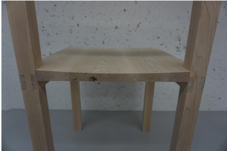
Figure 3.6 Courbure de l'assise : Prototype 1
