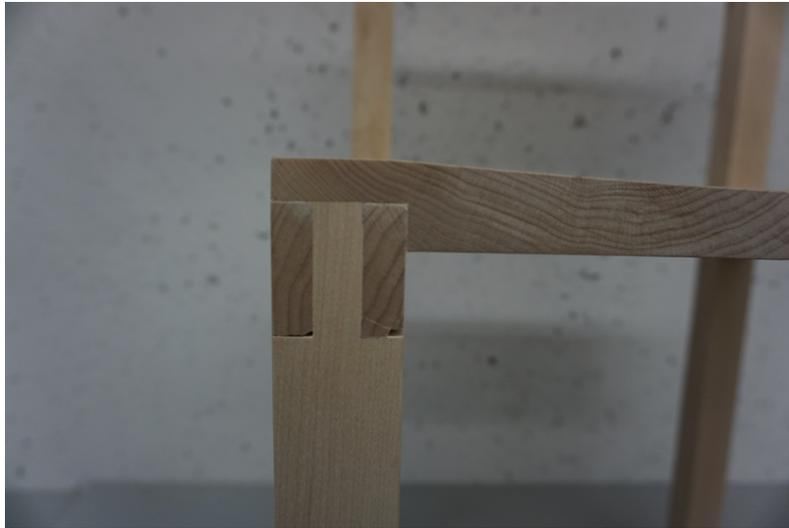
Figure 3.7 Éclatement de la fibre de bois : Prototype 1
