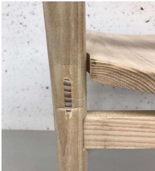
Figure 3.24 Écrasement de la fibre : Prototype 3
