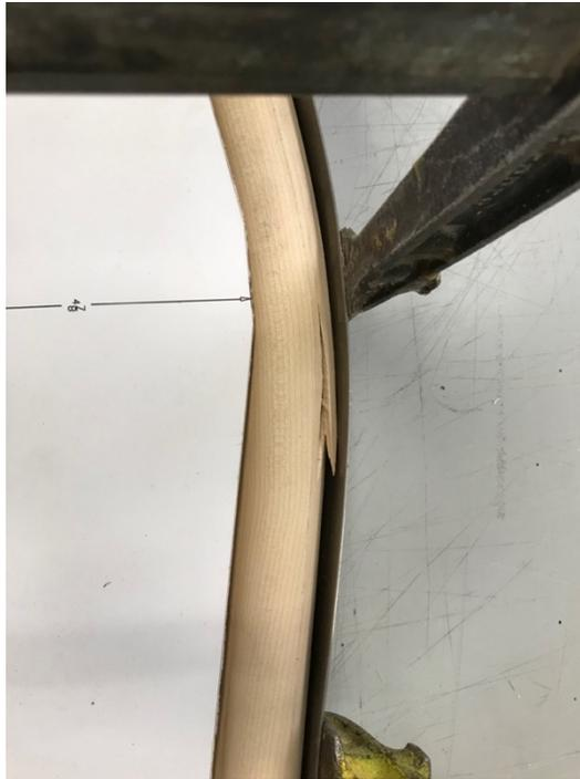
Figure 3.46 Éclatement de la fibre, bois d'érable : Prototype 3
