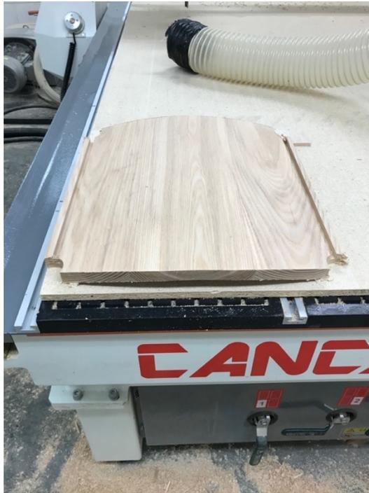
Figure 3.42 Usinage assise commande numérique : Prototype 3
