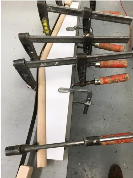
Figure 3.30 Test de cintrage érable : Prototype 3
