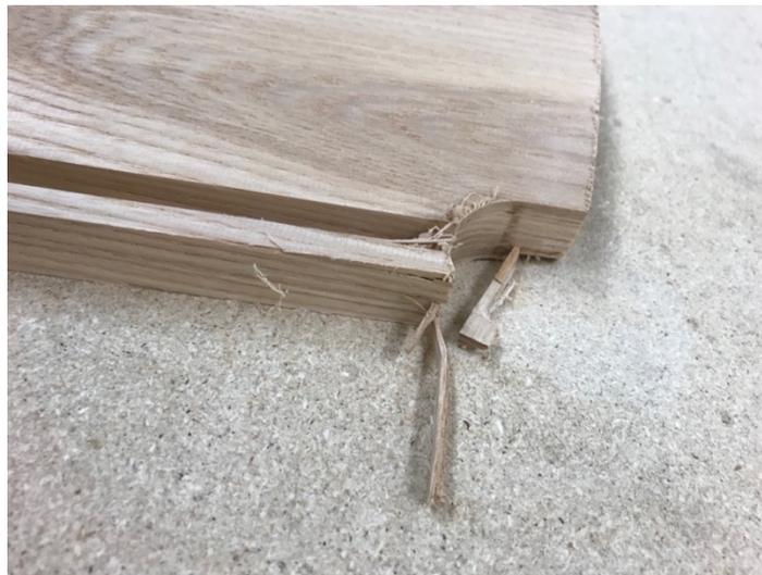
Figure 3.22 Éclatement de la fibre : Prototype 3
