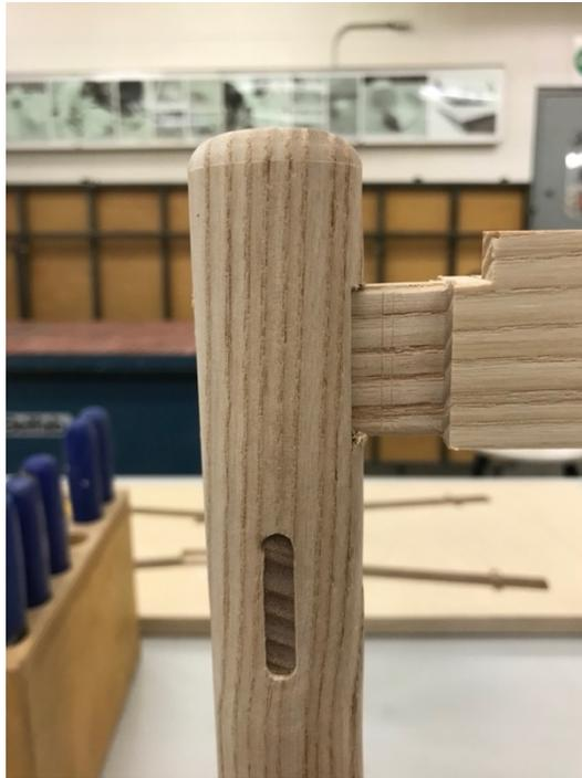
Figure 3.40 Assemblage patte avant et traverse : Prototype 3
