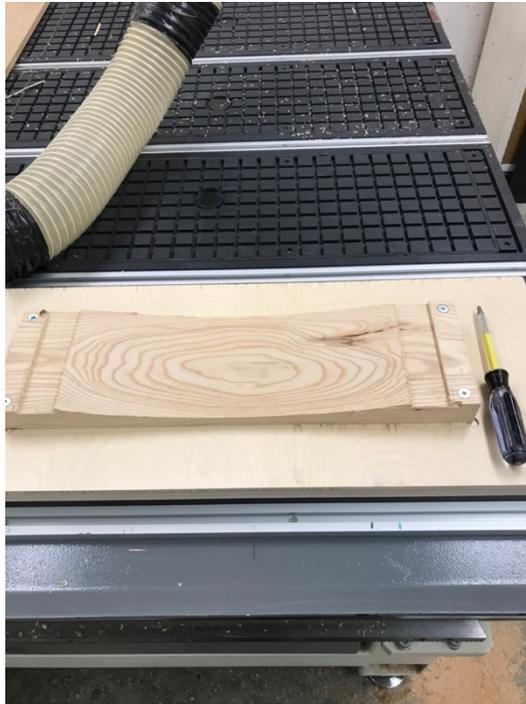
Figure 3.94 Usinage face concave dossier commande numérique : Chaise finale
