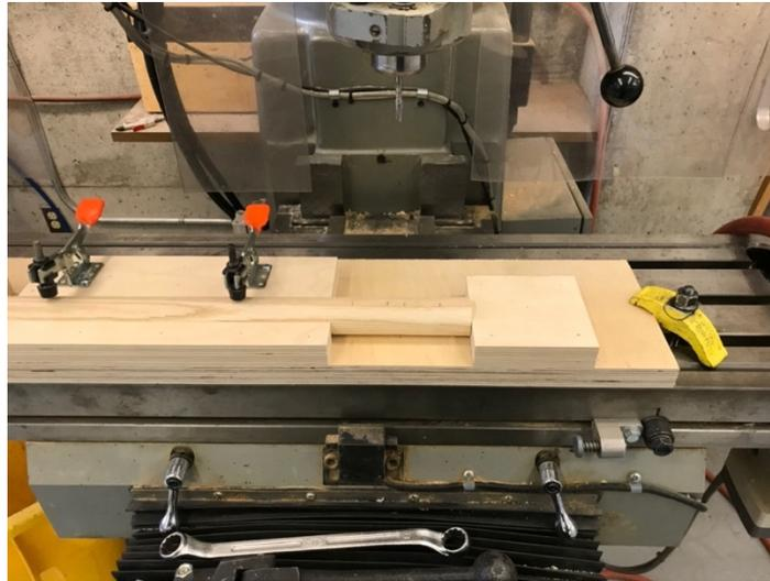
Figure 3.34 Gabarit usinage patte avant : Prototype 3
