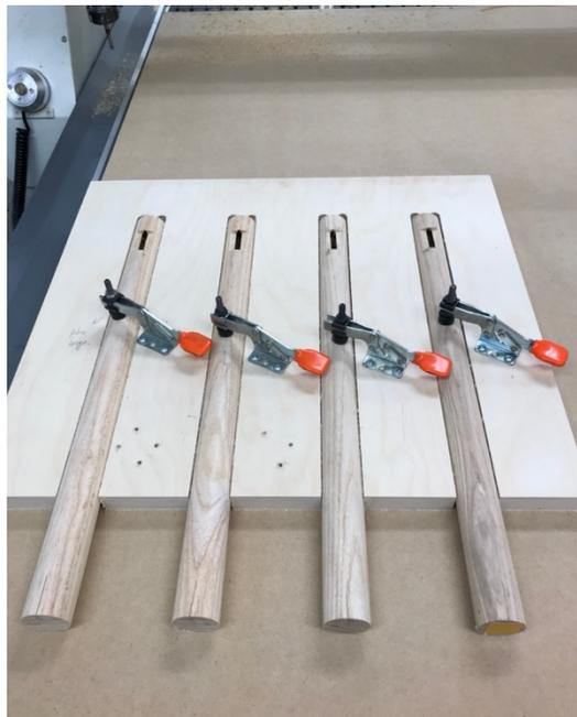
Figure 3.61 Gabarit d'usinage mortaise pattes avant : Chaise finale
