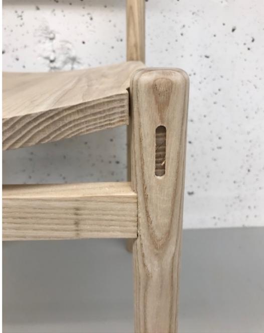
Figure 3.23 Tenon-mortaise mal ajusté : Prototype 3
