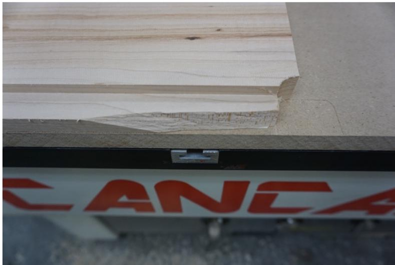
Figure 3.18 Éclatement fibre : Prototype 2
