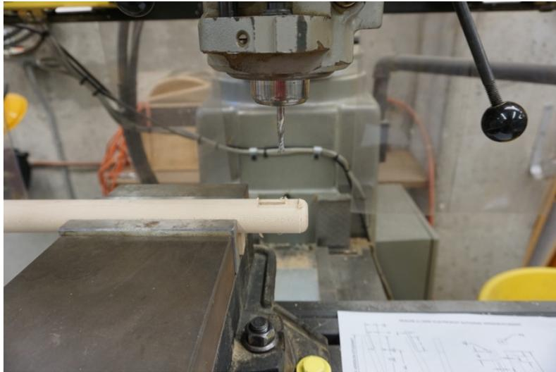
Figure 3.13 Usinage assemblage mortaise : Prototype 2
