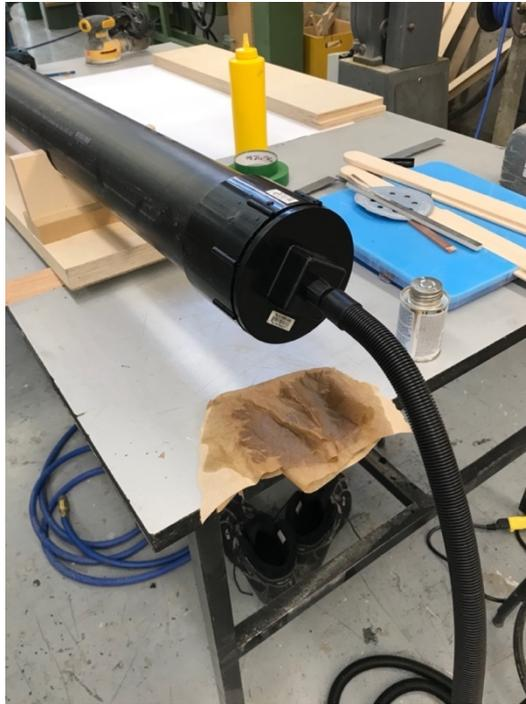
Figure 3.28 Étuveuse pour cintrage : Prototype 3
