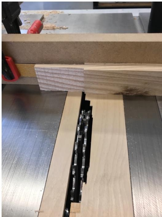
Figure 3.56 Usinage tenon de traverse : Chaise finale
