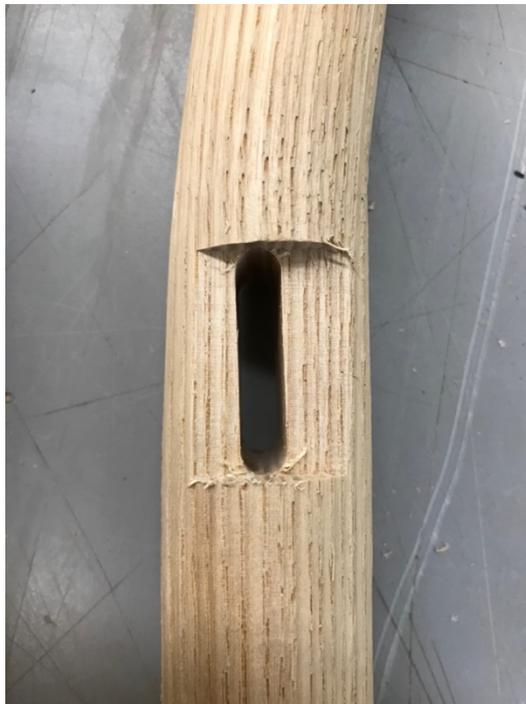
Figure 3.33 Mortaise patte arrière : Prototype 3
