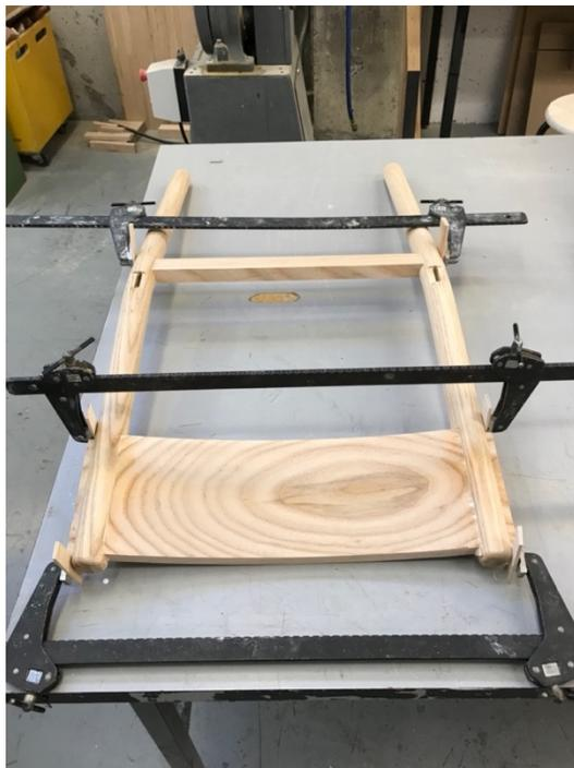
Figure 3.43 Assemblage partie arrière : Prototype 3
