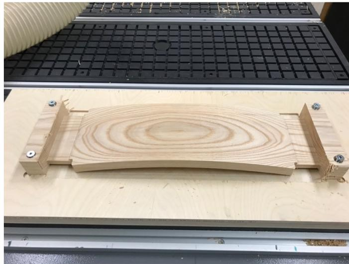
Figure 3.95 Usinage face convexe dossier commande numérique : Chaise Finale
