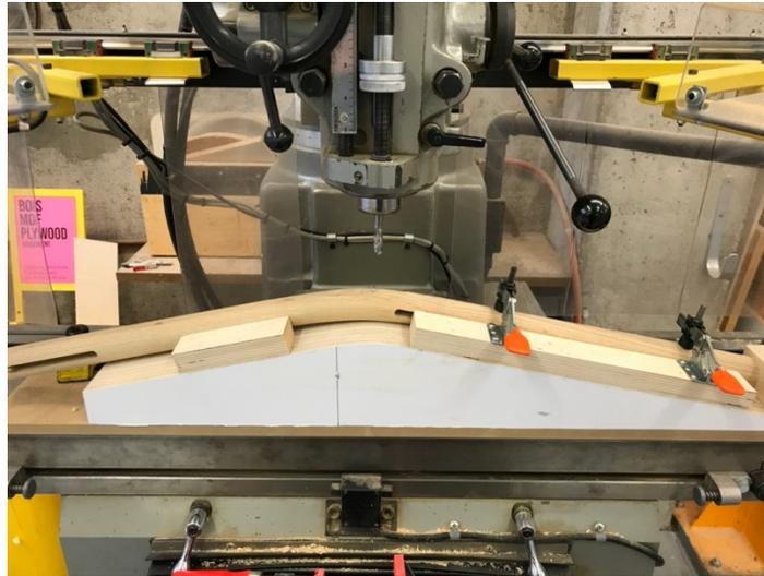
Figure 3.92 Gabarit usinage assemblage pattes arrières commande numérique : Chaise finale
