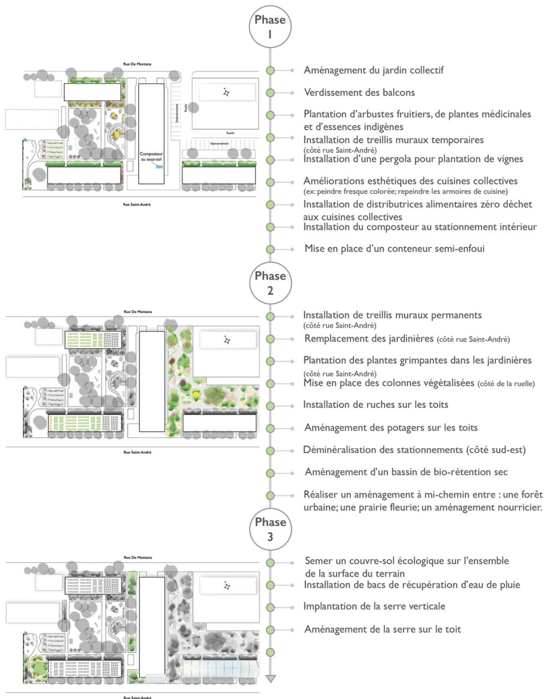
Figure 6.5 Les trois phases d'implantation des interventions
