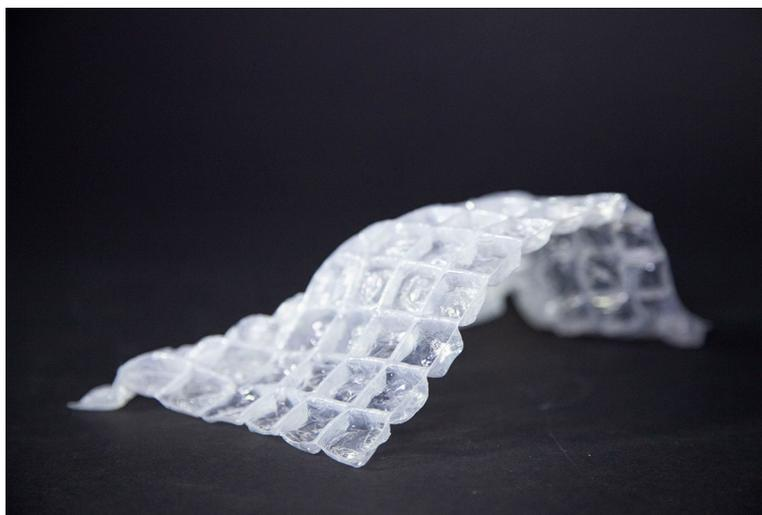
Figure II.11 Exemples de plaques thermoformées deux fois selon deux moules différents
