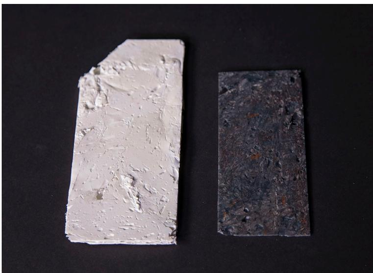
Figure II.2 Exemples d'emballages souples compressés et fondus dans un moule
