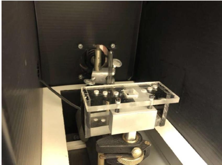
Figure 3.1 Photoréacteur utilisé pour les expériences de photolyse.
