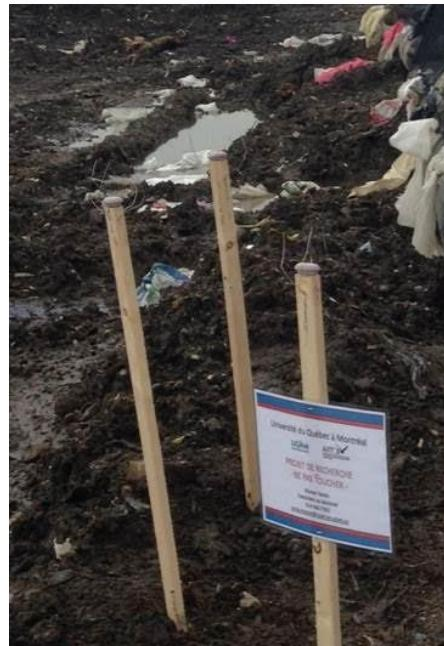
**Figure E.1** Échantillonneurs passifs d'air miniatures stationnaires placés au front des déchets dans un lieu d'enfouissement technique de la région de Montréal (QC, Canada) au printemps 2015.
