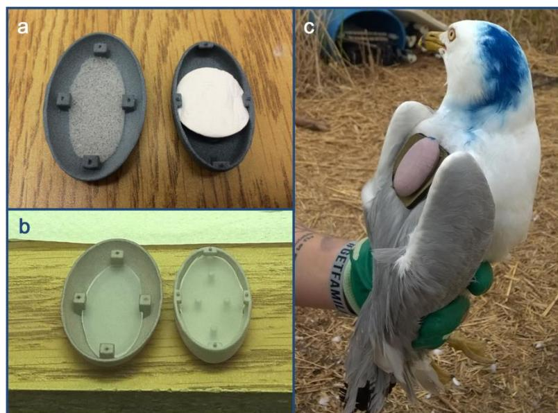
**Figure 0.10** Échantillonnage passif d'air adapté aux goélands à bec cerclé. a) Partie supérieure de la chambre de l'échantillonneur présentant un filtre de mousse de polyuréthane (gauche) et partie inférieure présentant un filtre de fibre de verre (droite). b) Partie supérieure de la chambre de l'échantillonneur (gauche) et partie inférieure (droite) présentant un filtre de ploydiméthylsyloxane. c) Goéland à bec cerclé équipé d'un échantillonneur fixé avec un harnais.
