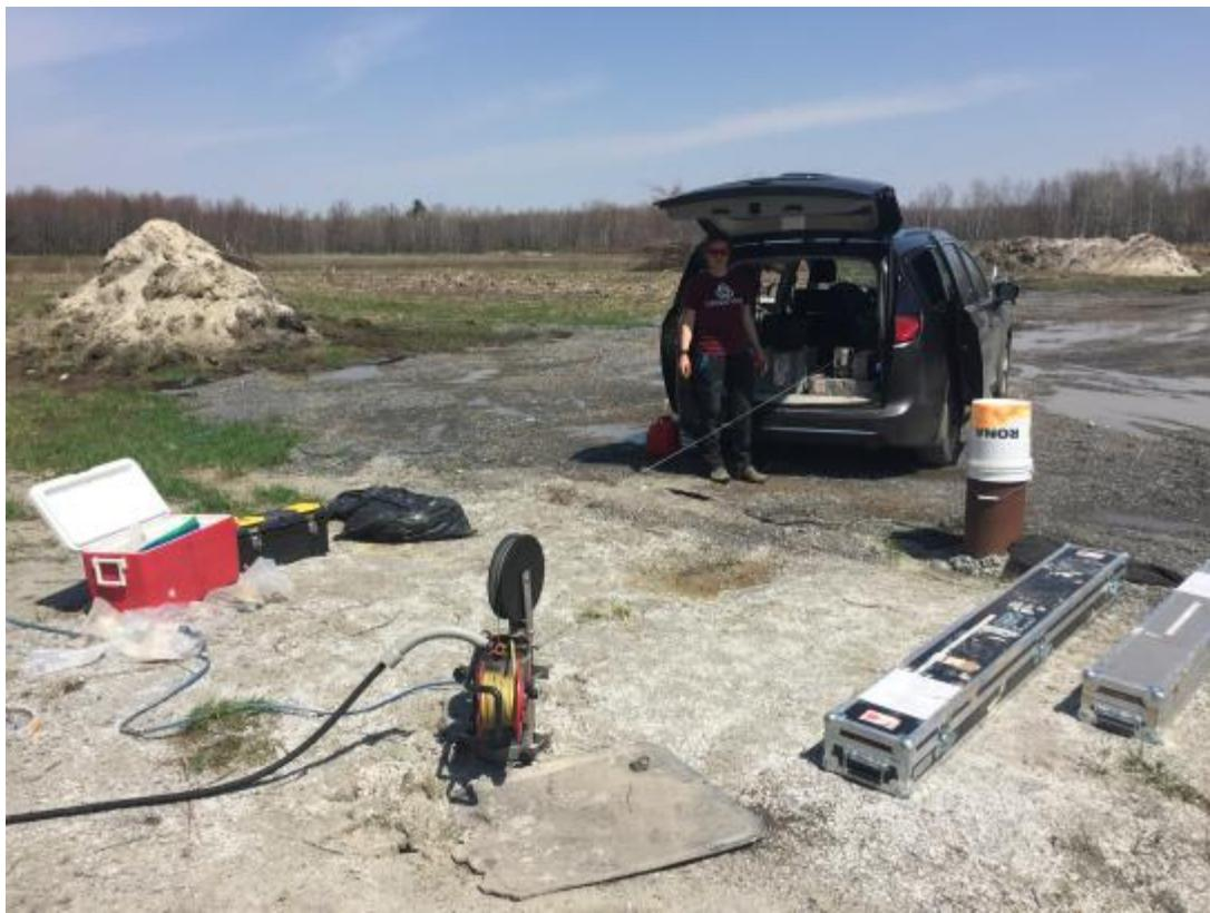
**Photographie 1 : Plan d'ensemble de l'installation pour réalisation de diagraphies physiques (site de Ormstown)**
