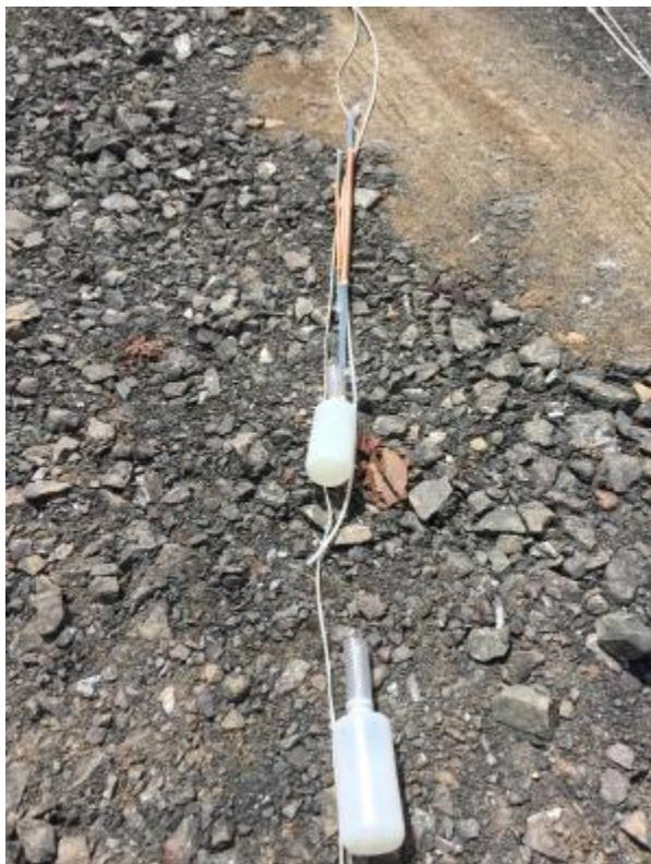
**Photographie 17 :** Mise en place d'échantilleurs passifs pour l'eau et les gaz sur la ligne avant leur insertion dans le puits (site de Saint-Apollinaire)
