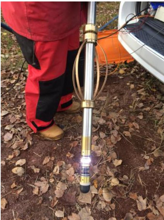
Photographie 11 : Plan rapproché de la caméra avec centreurs utilisée pour les diagraphies
