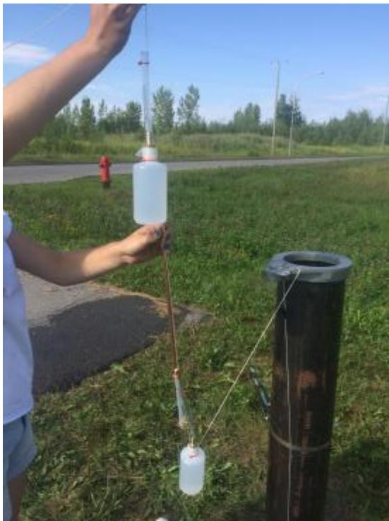
**Photographie 19 : Mise en place d'échantillonneurs passif liquides et gaz sur une ligne lestée (site de Coteau-du-Lac)**
