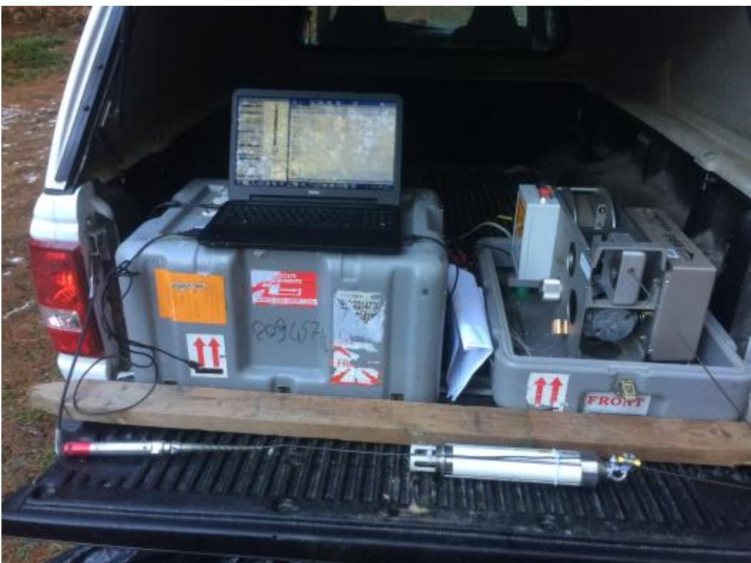
Photographie 6 : Configuration d'équipement diagraphique à l'arrière du véhicule : treuil et console contrôlés par ordinateur, thermistance fixée en série sur le câble comprenant à son extrémité le connecteur pour les équipements (camera, micromoulinet)
