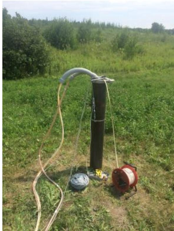
**Photographie 4 : Puits équipé pour les essais de traçage avec conduite de pompage et conduites de lignes d'injection**
