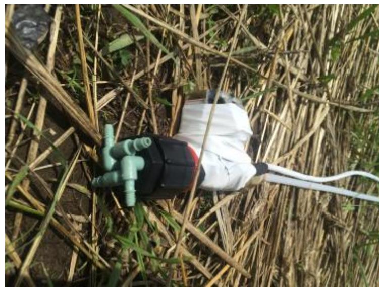
**Photographie 5 : Plan rapproché d'une électrovanne pour l'injection de traceur**
