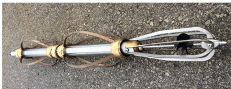
Figure 1.3 : Micromoulinet équipé de centreurs (Terraplus, 2014b)
