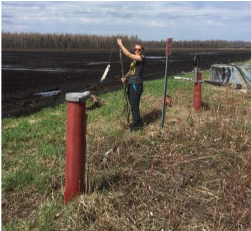
Photographie 4 : Préparation à l'insertion d'équipement en série (sonde température haute résolution et micro-moulinet) dans un puits pour diagraphie (site de Chateauguay)
