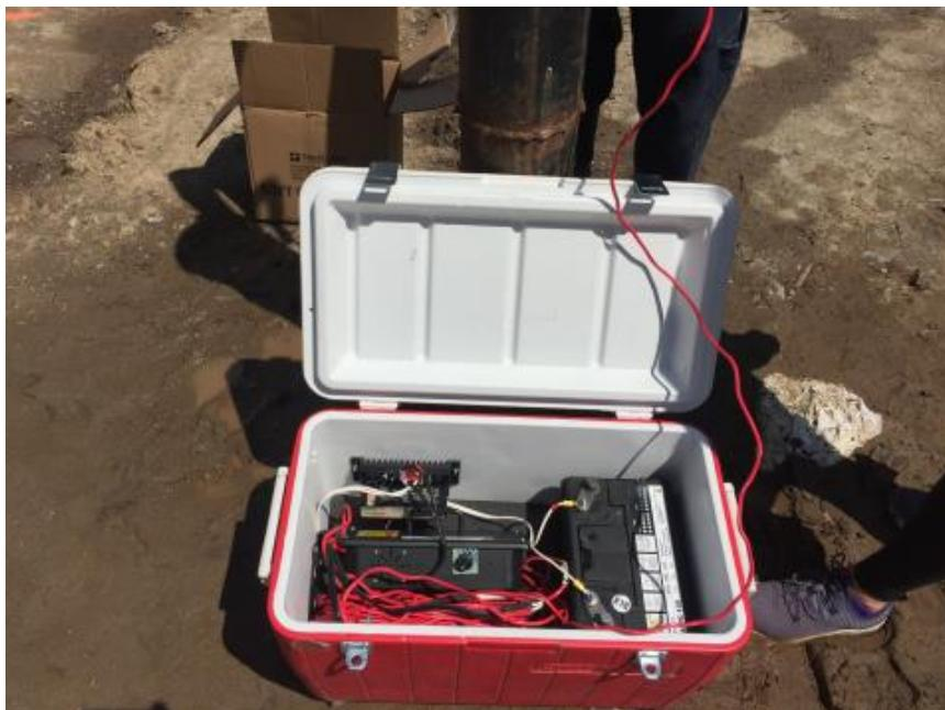
**Photographie 24 :** Plan rapproché de l'intérieur du système autonome d'alimentation utilisé pour le micro-pompage pour fin de datation séquentielle. Batterie à décharge profonde, régulateur de tension de la pompe et relais de régulation de charge depuis le panneau solaire (site de Saint-Apollinaire)
