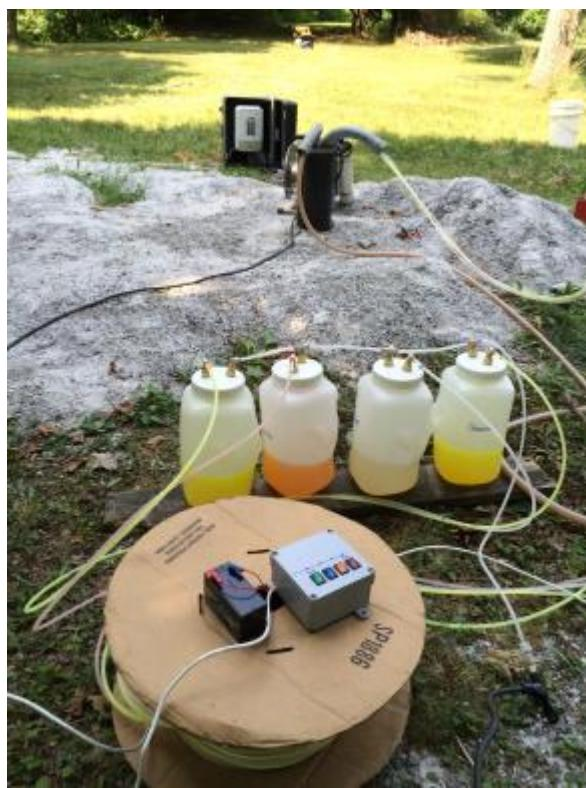
**Photographie 6 : Déploiement de la ligne avec 4 injecteurs, site de Hemmingford**
