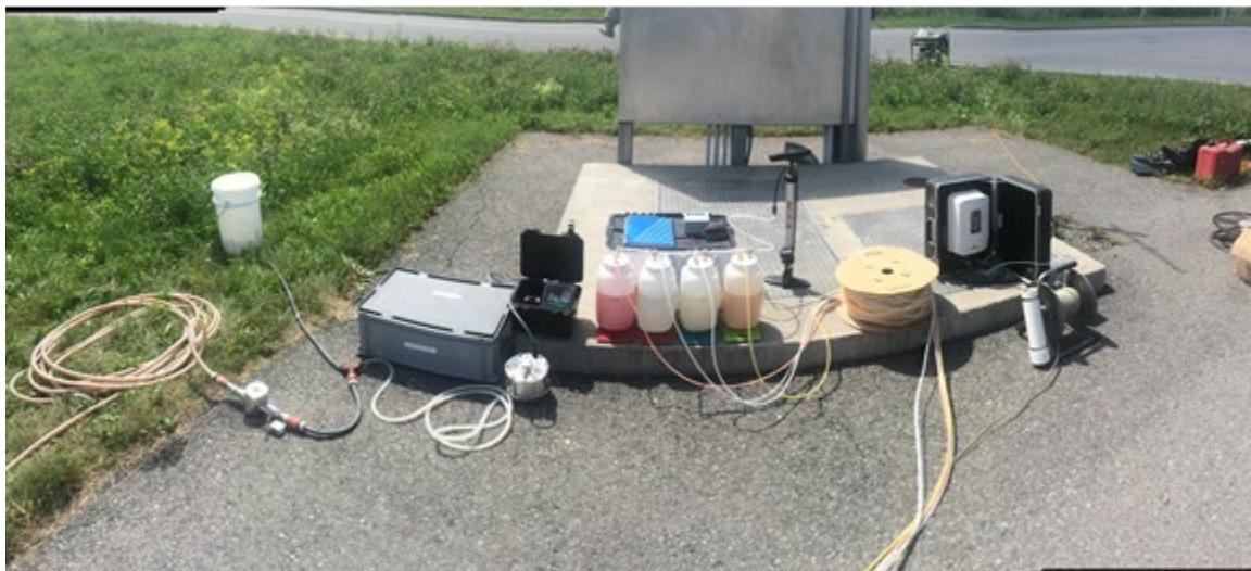
**Photographie 2 :** Schémas d'installation complet pour l'injection par impulsions (site de Coteau-du-Lac), de droite à gauche : Pompe submersible et régulateur, Ligne d'injection dans l'enrouleur, réservoirs sous pression pour l'injection (Uranine, Tinopal, Eosine et NaCl) et contrôleur d'électrovanne, fluorimètre et système d'acquisition, compteur volumétrique du débit pompé.
