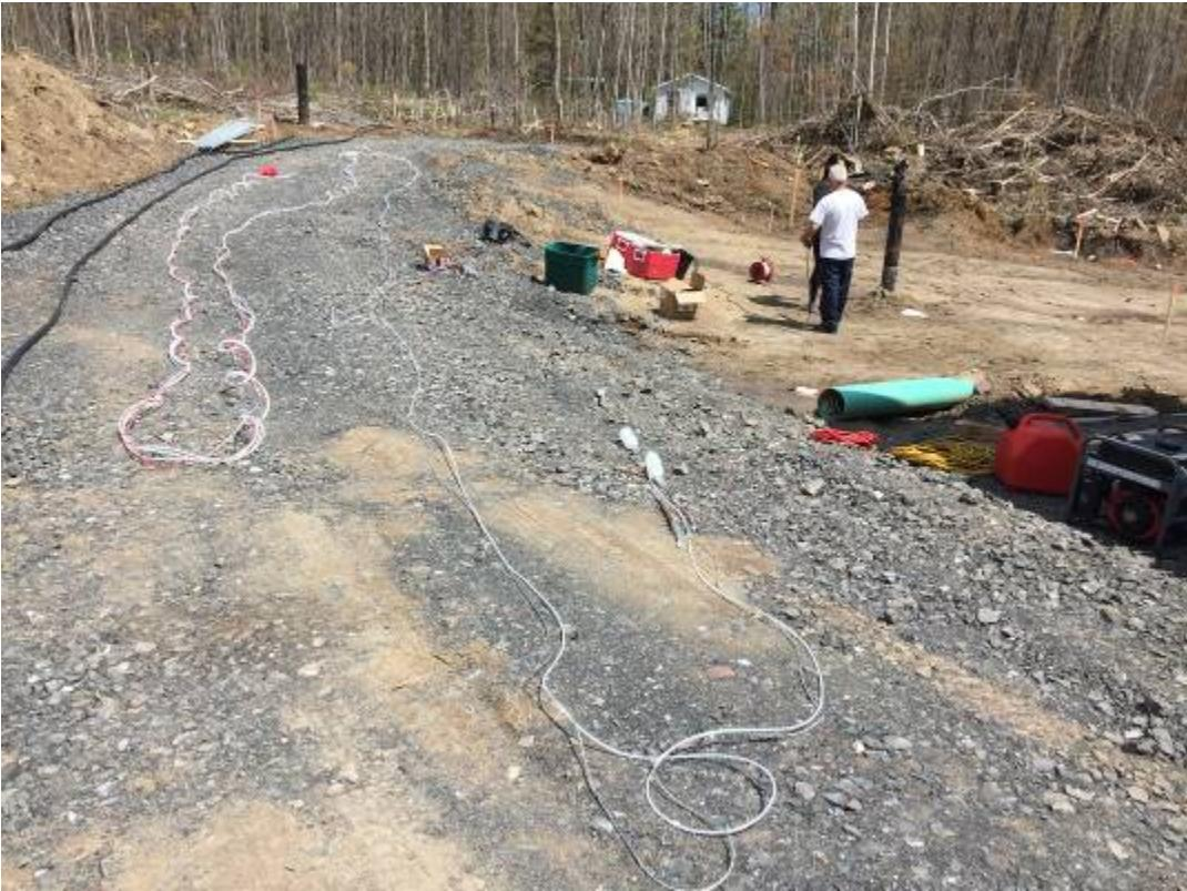
**Photographie 15 :** Déploiement d'une ligne de micro-pompage pour l'échantillonnage séquentiel de traceurs et de la chimie de l'eau et avant insertion dans le puits (site de Saint-Apollinaire)
