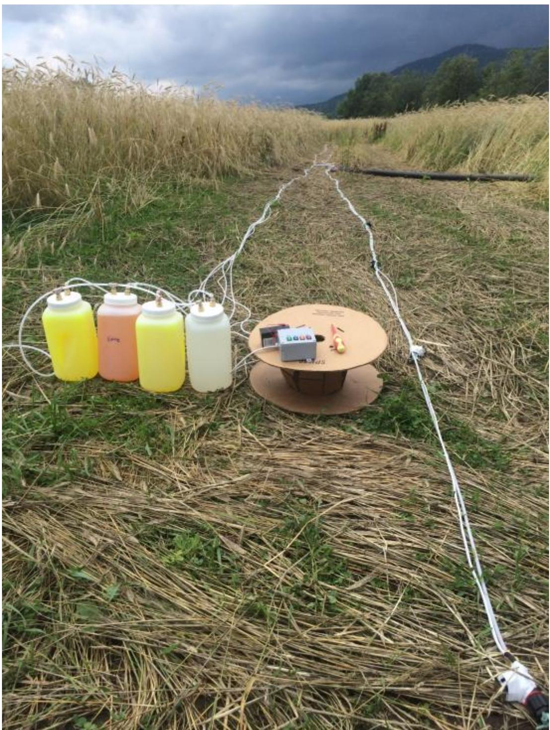
**Photographie 3 : Déploiement de la ligne avec 4 injecteurs (Uranine, Eosine, Tinopal et NaCl,
