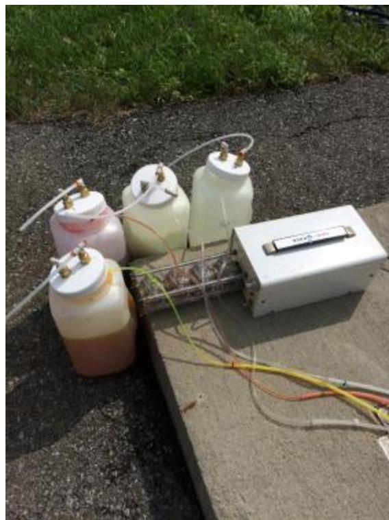
**Photographie 7 : Plan rapproché de la pompe péristalique utilisée en mode d'injection continue**
