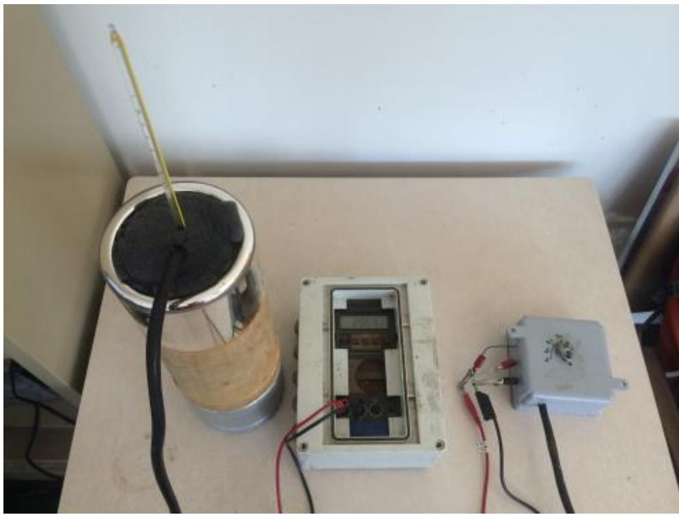
**Photographie 9** Calibration de la thermistance utilisée jusqu'en 2017. De gauche à droite : Contenant isotherme avec thermistance et thermomètre, Ohmmètre digital ( $\pm 0.01\Omega$ ), boîtier de résistance en série pour la thermistance
