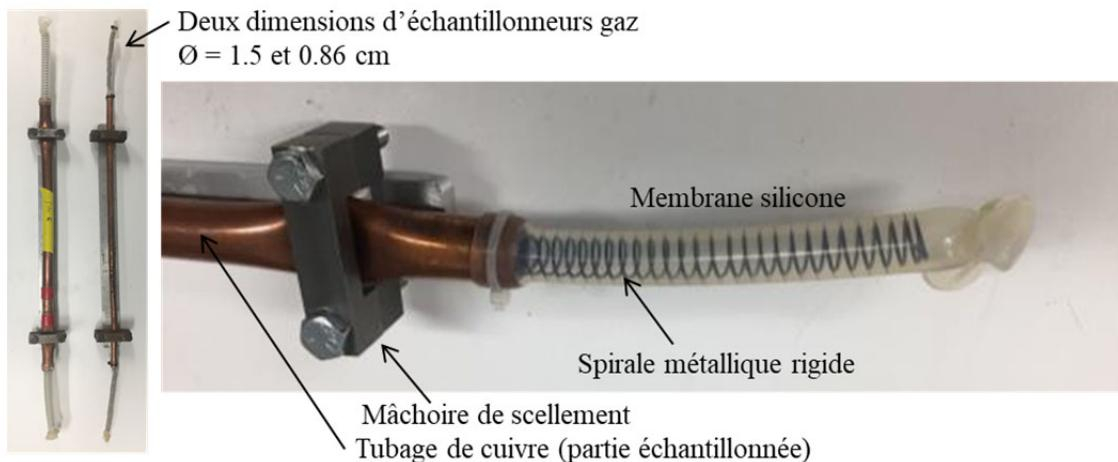
Figure 2 : Échantillonneurs passifs pour les CFCs/SF6 développés au laboratoire de géochimie des ressources en eau du GEOTOP-UQAM
