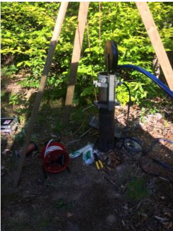
Photographie 5 : Installation avec trépied et pour diagraphie avec pompage en profondeur à débit important (130 L/min), (site de Saint-Lazare)
