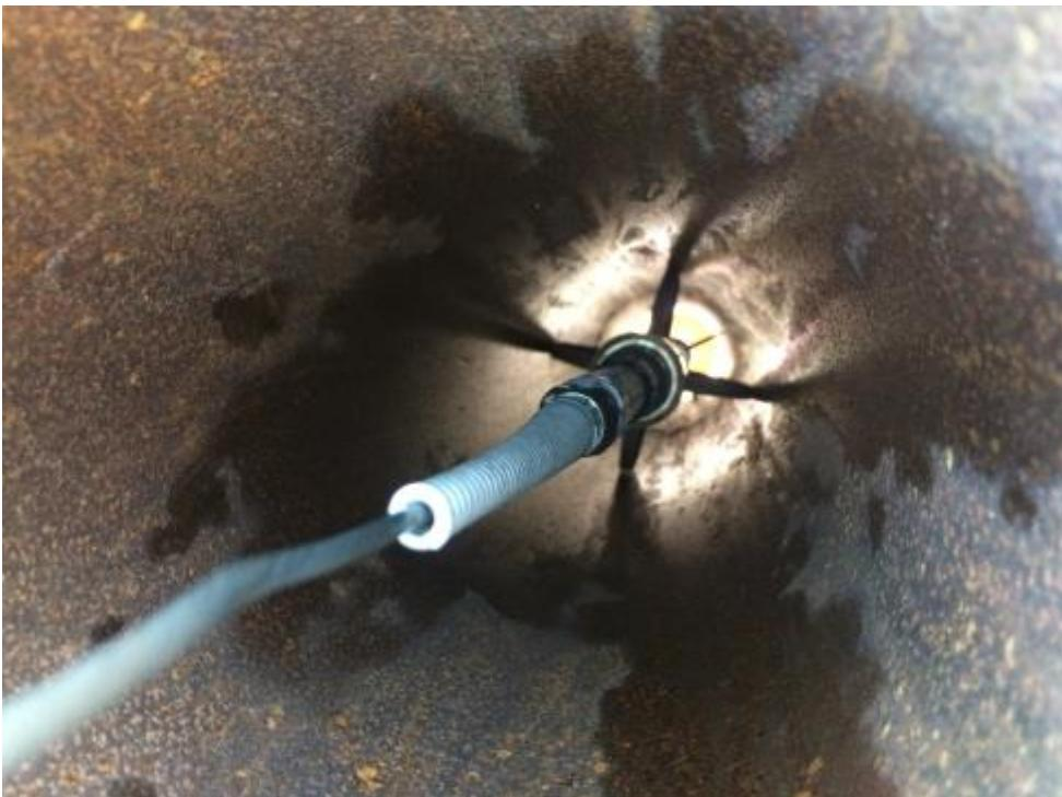
Photographie 12 : Caméra en remontée finale dans le tubage d'un puits de 150 mm de diamètre
