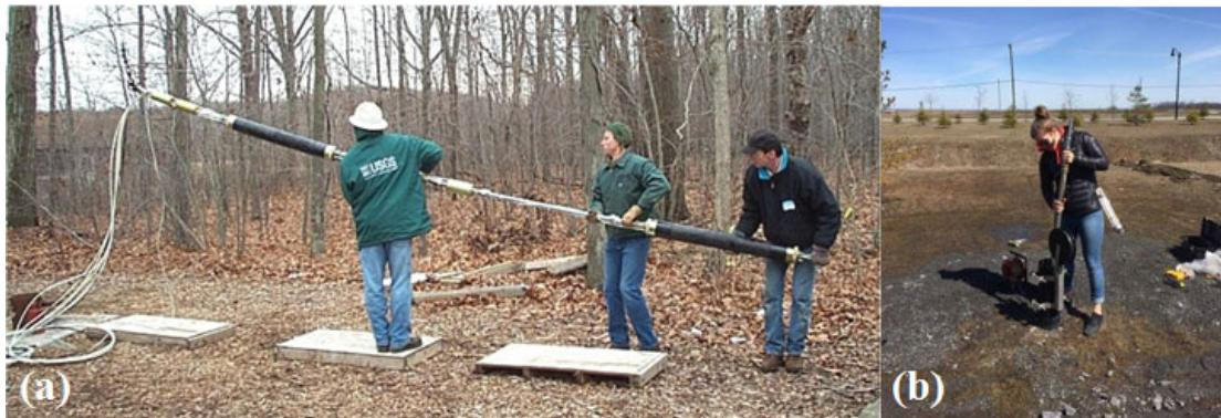
Figure 1.2 : (a) Montage pour un essai par obturateur (USGS), (b) mise en place d'un micromoulinet (UQAM)
