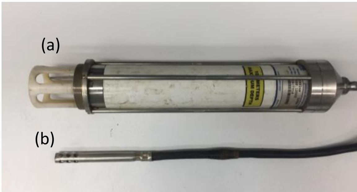
Photographie 8 : Plan rapproché des thermistances utilisées : (a) Thermistance  $\pm 0.001^\circ\text{C}$  équipée incluant un système programmable d'acquisition de données avec sonde de pression et (b) thermistance  $\pm 0.01^\circ\text{C}$  utilisée jusqu'en 2017
