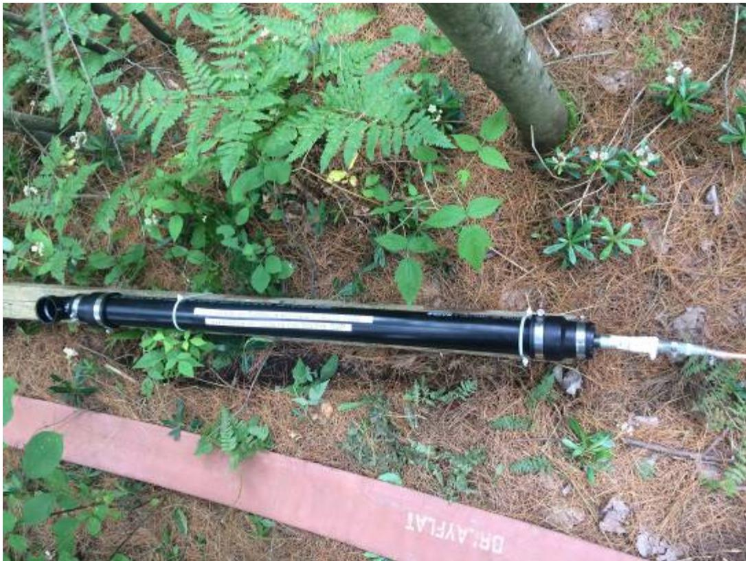
**Photographie 22 : Déploiement d'une chambre de rééquilibration pour échantilleurs passifs pour les gaz, installée pour sur une dérivation de la conduite principale d'un essai de pompage de longue durée (site de Saint-Lazare)**
