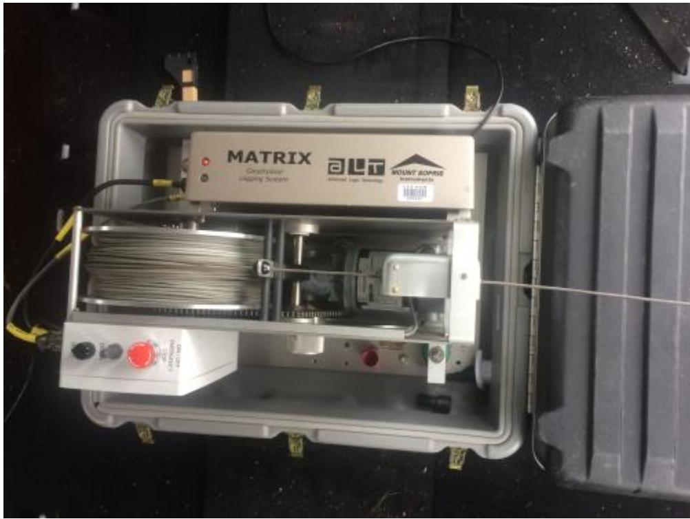
Photographie 7 : Treuil mécanique, console de contrôle et câble de communication pour les diagraphies physiques
