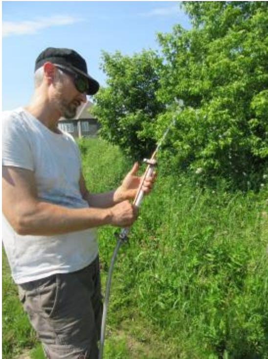
**Photographie 21 : Échantillonnage conventionnel d'eau souterraine pour les gaz rares à l'exutoire d'une dérivation de la conduite de pompage (tubes de cuivre 3/8")**
