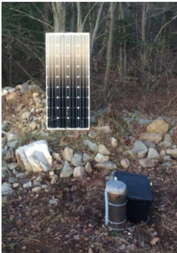
**Photographie 23 :** Installation de pompage autonome pour le forçage des flux d'eau dans le puits pour fins de datation séquentielle avec échantillonneurs passifs : panneau solaire et boîtier d'alimentation adjacents au puits (site de Saint-Paul-d'Abbotsford)
