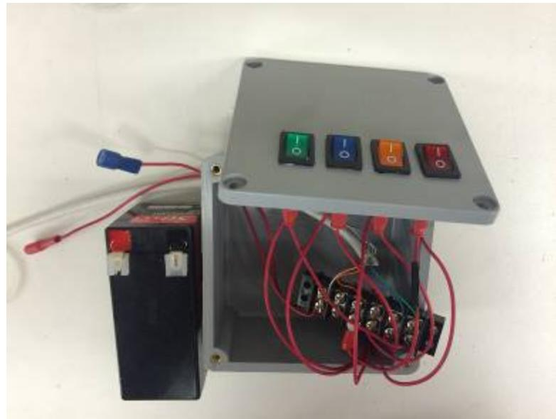
**Photographie 8 :** Boîtier de contrôle pour l'ouverture/fermeture des électrovannes d'injection relié à une batterie 12V.
