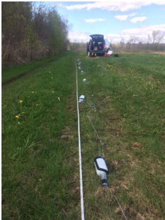
**Photographie 18 :** Préparation d'une série de dix échantilleurs passifs sur une ligne lestée pour fin de datation séquentielle avant insertion dans le puits (site de Saint-Paul-d'Abbotsford)
