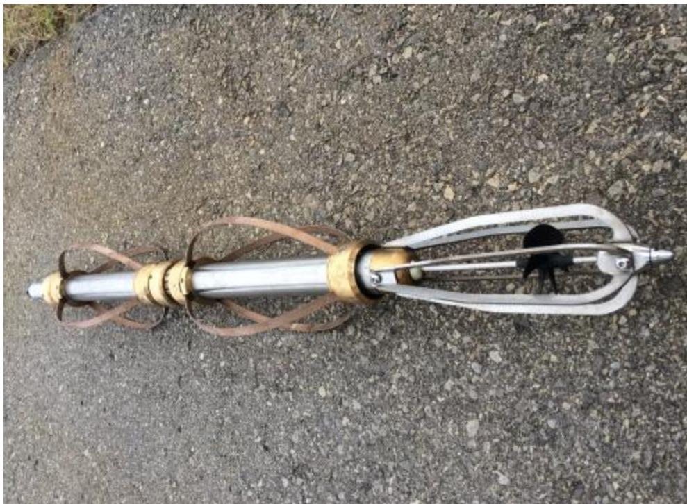
**Photographie 10 :** Plan rapproché du micromoulinet avec centreurs utilisé pour les diagraphies
