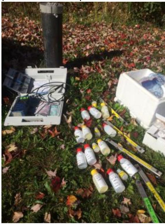
**Photographie 20 : Préparation de flaconnages et de mâchoires préliminaires à la récupération d'échantillonneurs liquides et gazeux en place dans un puits (site de Saint-Paul-d'Abbotsford)**
