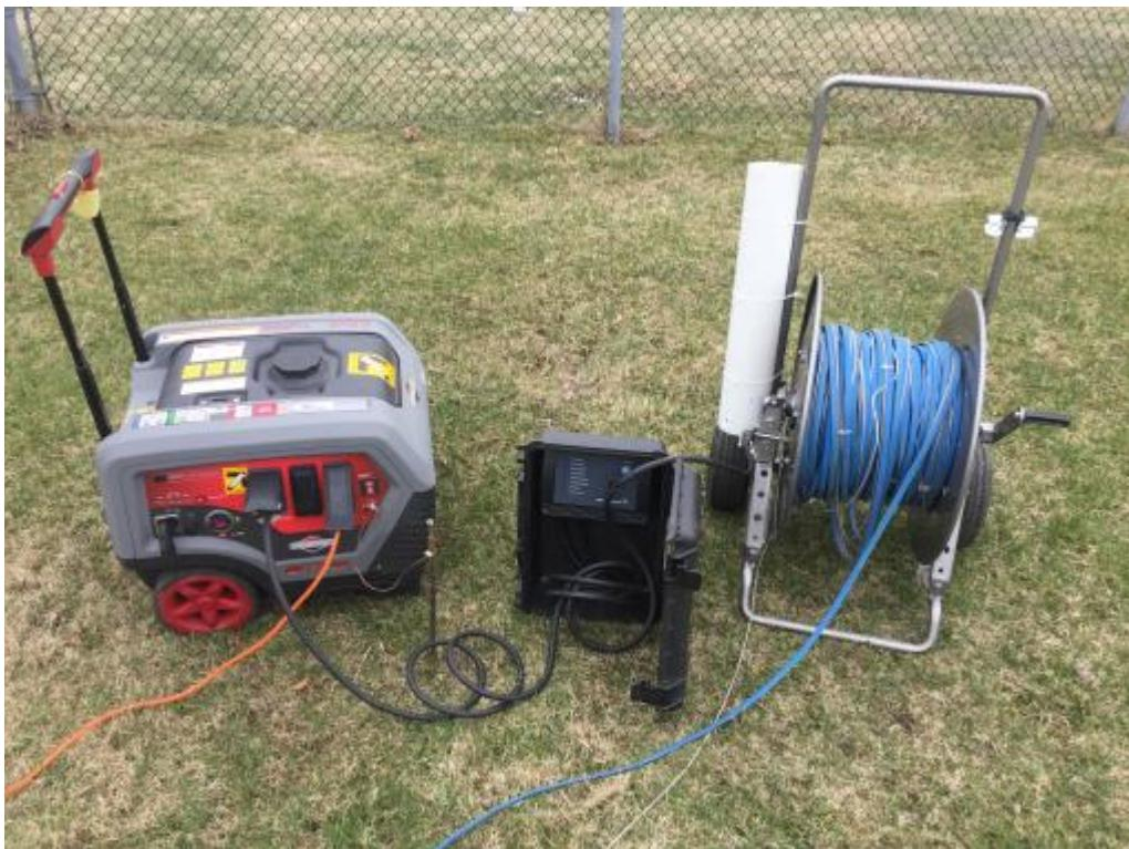
**Photographie 13 :** Câblage et contrôleur de pompe submersible à débit variable et génératrice compacte utilisés pour les investigations diagraphiques
