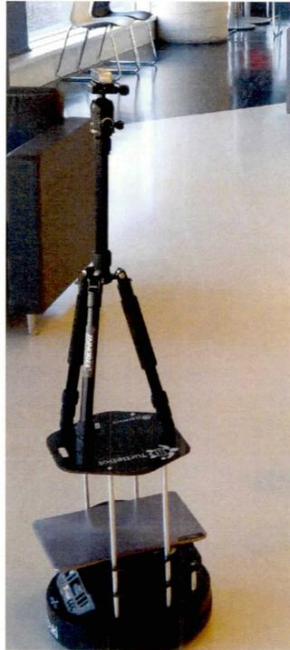
Figure 5.1: Système PARC déployé sur un robot TurtleBot 2.
