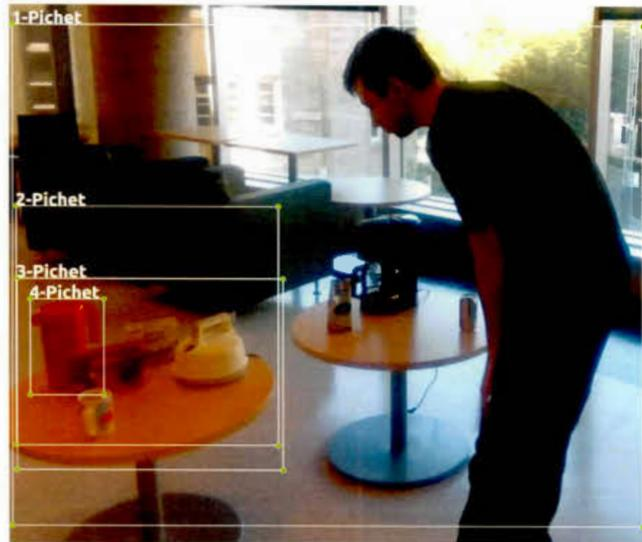
Figure 2.4: Représentations de différents cadres de limitation de zones avec un pichet. L'utilisation d'une régression linéaire permet d'optimiser le positionnement des coins du cadre pour contenir seulement la région d'intérêt (**ROI**) du pichet.
