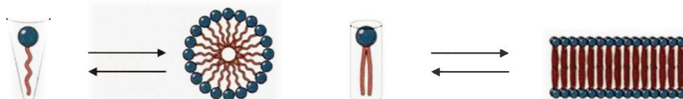
**Figure 2.1 :** Différents types de structures pouvant être formés par différents surfactants.
