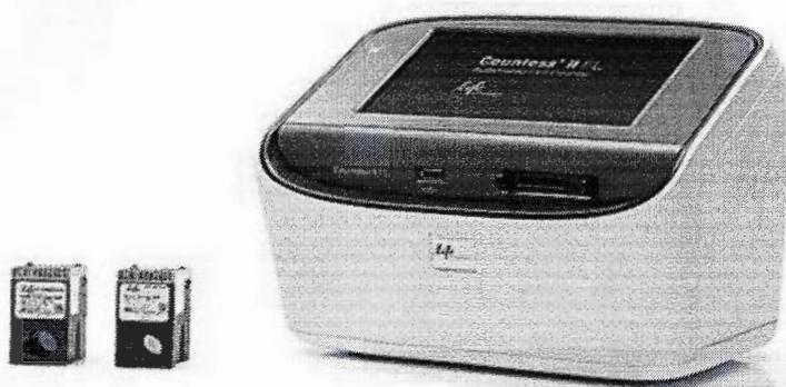
Figure 3.2 Le compteur automatisé de cellules Countess® II FL avec ses cubes lumineux. (Thermo Fisher scientifique)
