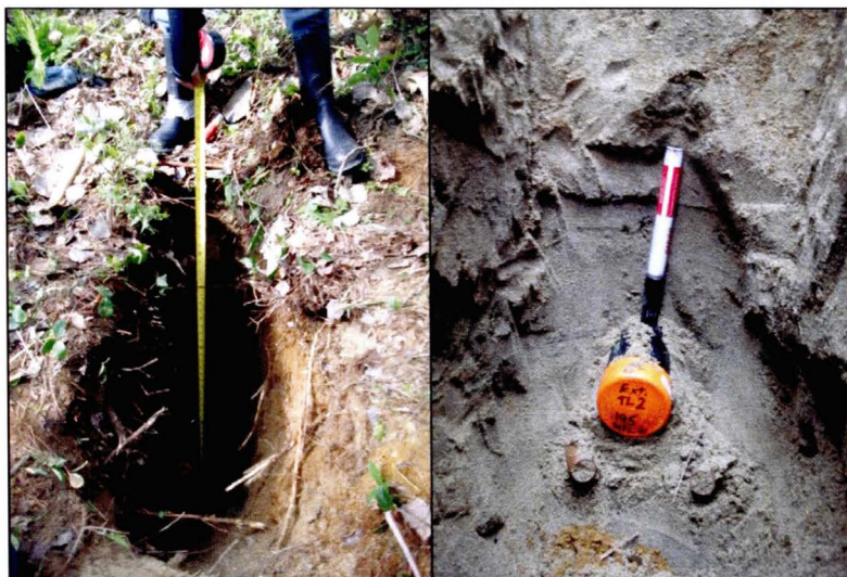
Figure 3.2 Échantillonnage de sédiments sableux. Le tube de PVC noir contient le matériel utilisé pour déterminer l'abondance en éléments radioactifs qui a été soumis à la stimulation optique, tandis que le contenu des deux tubes en cuivre a servi à établir la teneur et la saturation en eau du dépôt.
