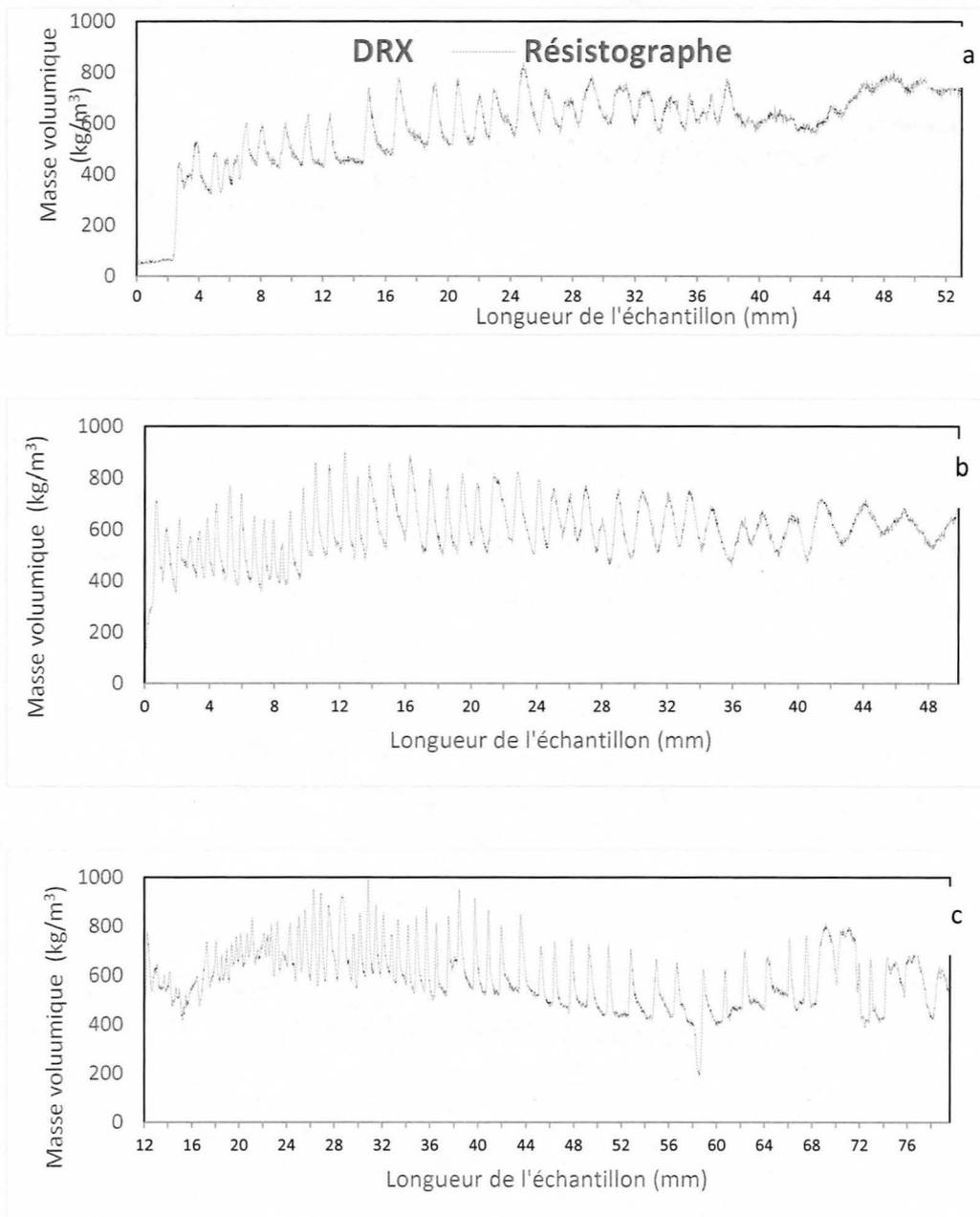
**Figure 4.1** Exemples du résultat de superposition de deux profils de variation radiale de la masse volumique (résistographe et DRX) en fonction de la longueur de l'échantillon allant de l'écorce jusqu'à la moelle (de gauche à droite)
