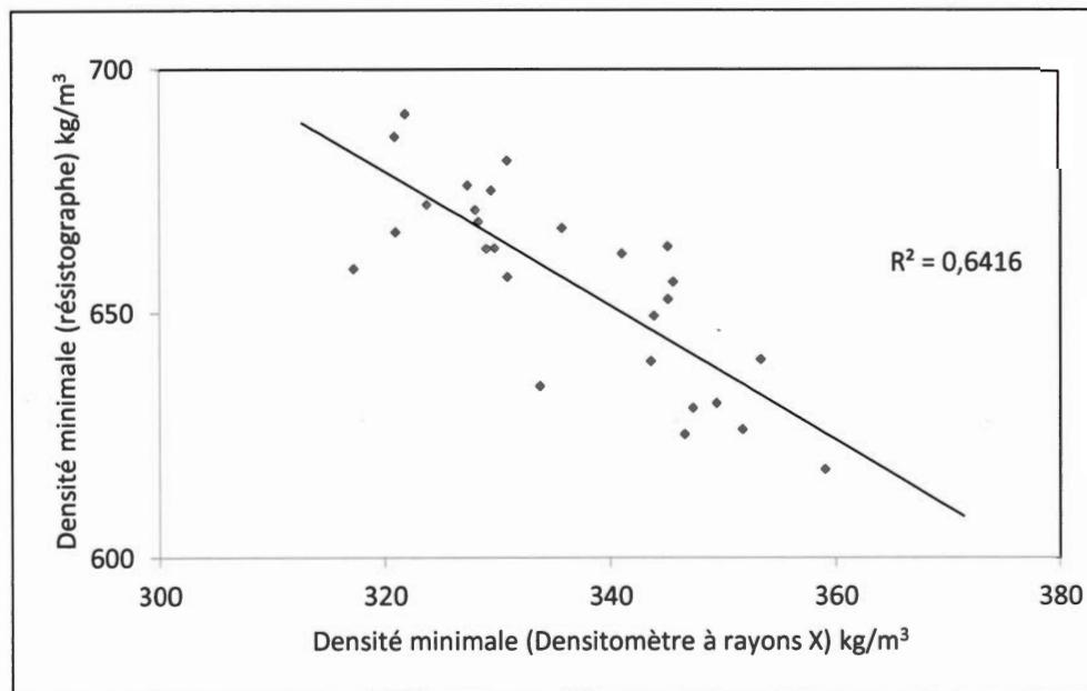
**Figure 4.4** Corrélation entre les données de la densité minimale du DRX et du résistographe pour les années de croissance (1970-2000)
