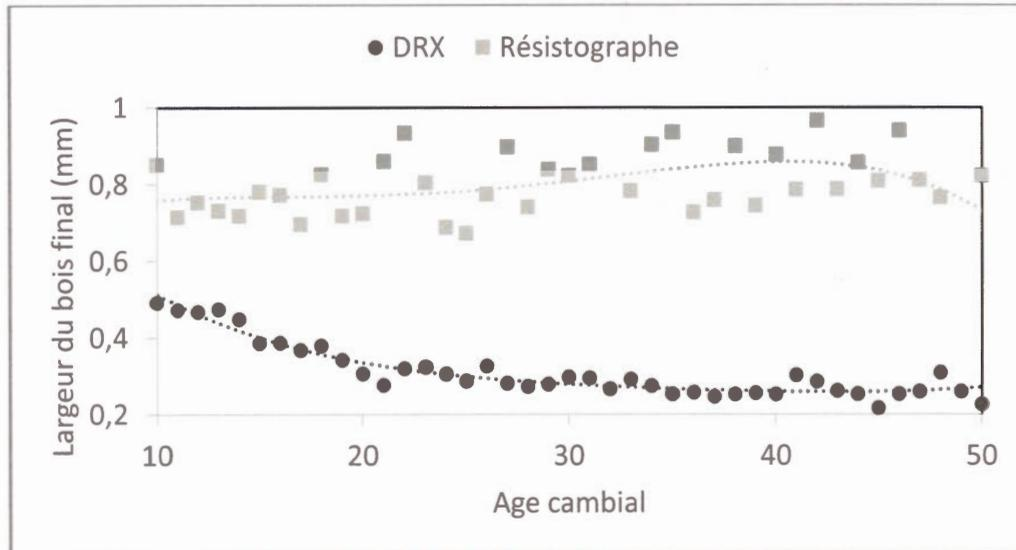
**Figure 4.18** Comparaison de la variation de la largeur du bois final pour les mesures du résistographe et du densitomètre à rayons X
