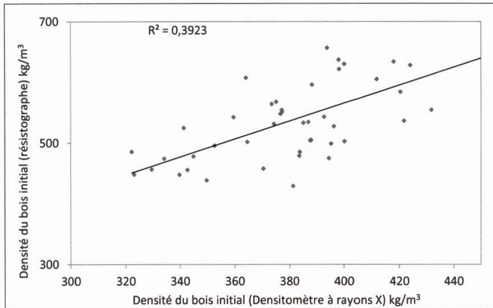
**Figure 4.5** Corrélation entre les données de la densité du bois initial du DRX et du résistographe pour les années de croissance (1970-2000)
