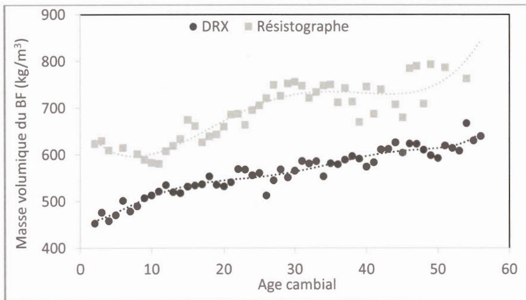
**Figure 4.15** Comparaison de la variation de la masse volumique du bois final pour les mesures du résistographe et du densitomètre à rayons X
