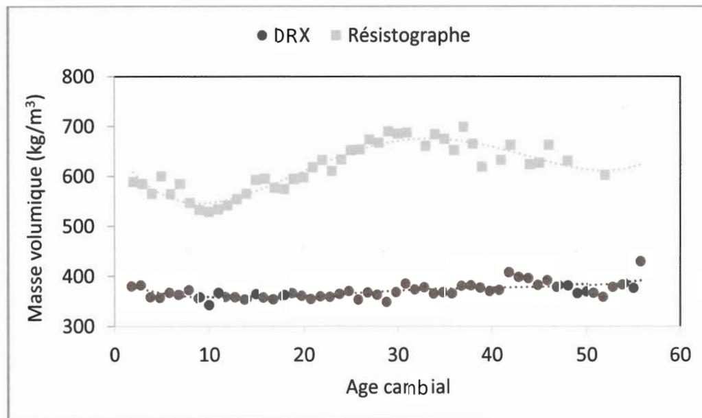
**Figure 4.14** Comparaison de la variation radiale de la masse volumique du bois initial pour les mesures du résistographe et du densitomètre à rayons X
