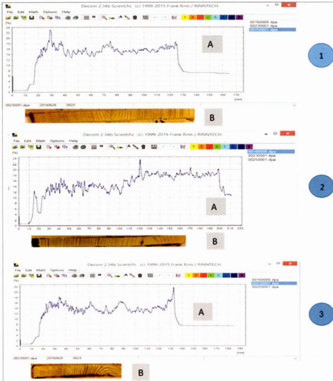
**Figure 3.5** Exemples de profils radiaux de trois épinettes noires (1,2 et 3) : Mesures du résistographe « A » analysées par le logiciel Decom 2.34b Scientific © 1999-2015
