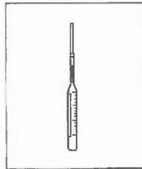
7. Retirer l'ampoule de l'appareil. Renverser l'ampoule (valve-tube vers le haut) et noter le chiffre indiqué par le niveau d'eau. Cette lecture donne la valeur de la dureté en mg/l.
