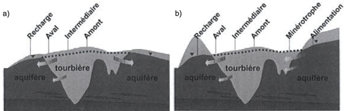
**Figure 0.2** Schéma conceptuel montrant les échanges aquifère-tourbière (flèches rouges et jaunes), les niveaux de nappe des tourbières (ligne pointillée) et des aquifères (triangles bleus) et des zones instrumentées pour les tourbières a) qui ne sont pas alimentées par les eaux souterraines et b) qui sont alimentées par les eaux souterraines.
