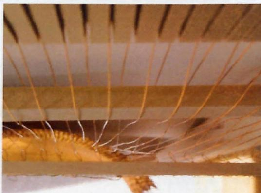
Figure 1.6 : Système pour relever les fils de chaîne
