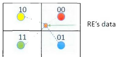
Figure 3.8: Décodage à décision dure QPSK
