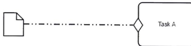
Figure 2.20 Visualiser la dépendance entre une tâche et un élément de fichier de cas utilisation du connecteur à base de sentinelle
