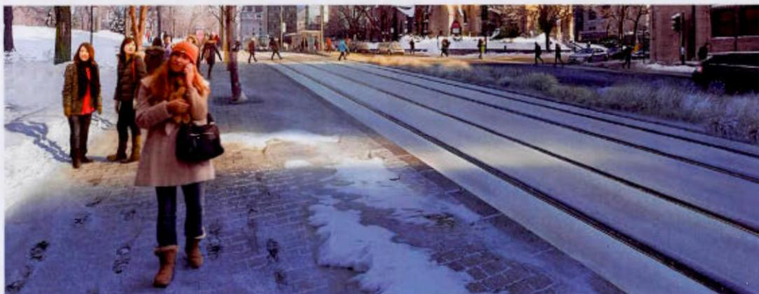
Image 5. Le site propre partiel démarqué de la voirie par un terre-plein et du trottoir par une variation de niveau et de pavement
