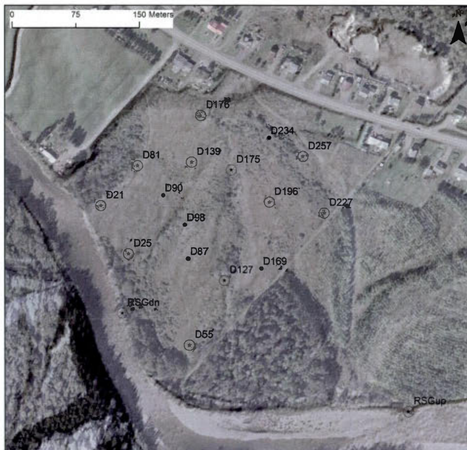
Figure 2.14 Distribution du réseau de piézomètres au site d'étude Dancause. Les points noirs représentent les piézomètres munis d'une sonde de température, les cercles étoilés représentent les piézomètres munis d'une sonde de pression.
