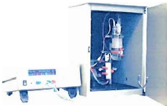
**Figure 2.12.** Microbalance de cristal de quartz (QCM922) reliée à une cellule de trois électrodes. Reproduit de Princeton Applied Research, [www.princetonappliedresearch.com](http://www.princetonappliedresearch.com).
