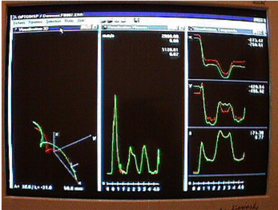
**Figure 31.** Logiciel Optodisp® (INSERM). Deux marqueurs sont respectivement collés sur les ongles de l'index et du pouce. De gauche à droite Visualisation 3D; Visualisation Vitesses (mm/s); Visualisation Temporelle (secondes) (D'après Expérience 3).
