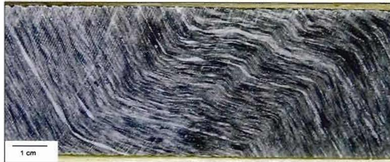
**Figure 2.11** : Plissement en kink band recoupant la schistosité.
