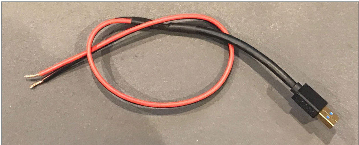
Figure 7.18 Adaptateur maison d'alimentation USB
