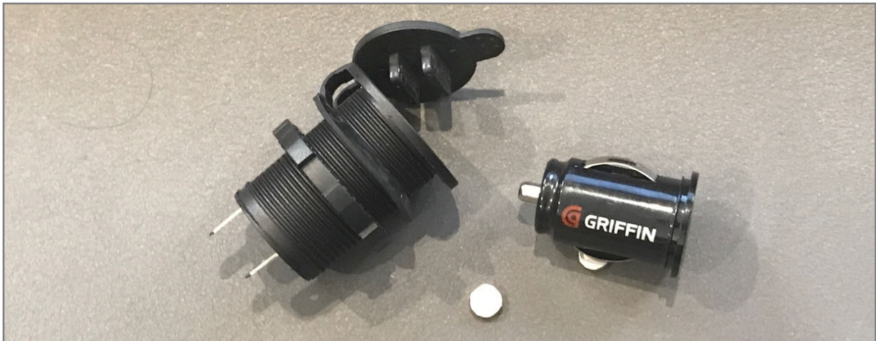
Figure 7.17 Pièces de l'adaptateur USB encastrable
