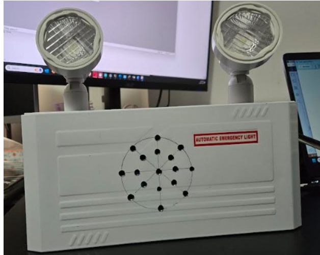
FIGURE 4.10 Appareil d'éclairage d'urgence conventionnel équipé du système de communication Modbus et WiFi, lampe éteinte
