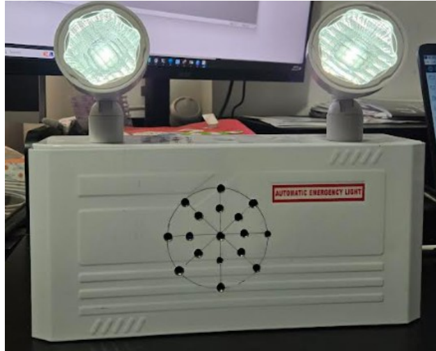
FIGURE 4.13 Appareil d'éclairage d'urgence conventionnel équipé du système de communication Modbus et Wi-Fi, lampe éteinte
