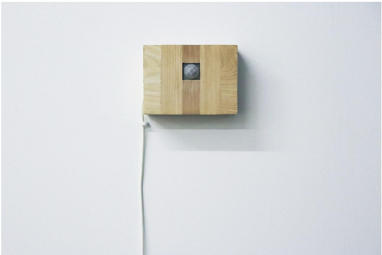
Figure 4.2 Marie-Pier Vanchestein, dispositif avec le capteur de présence et le ESP32 « serveur », installé près de la porte de la galerie, ELEKTRA, avril 2025.
