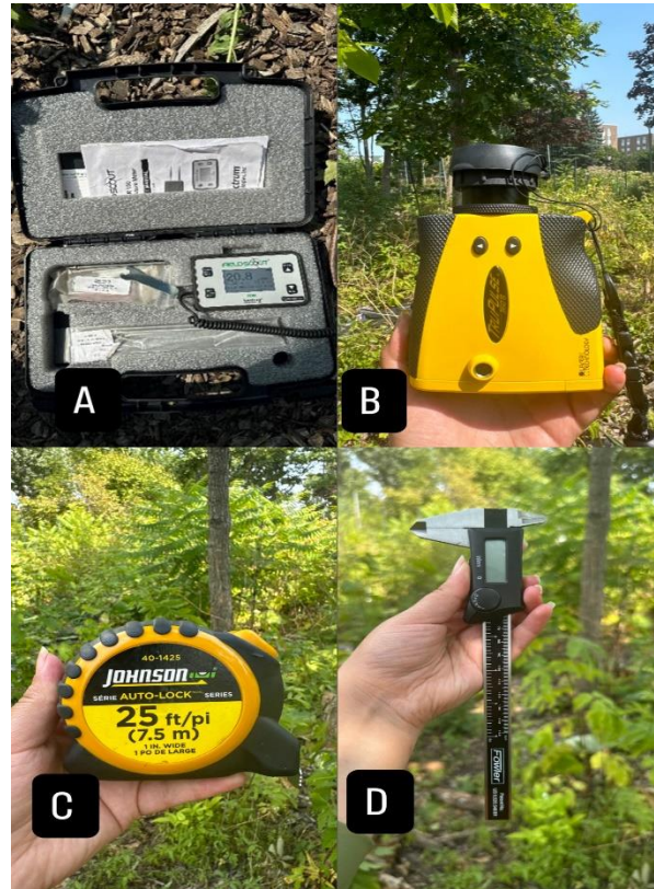
Figure 2. Matériel de mesure et d'échantillonnage utilisé sur le terrain A : TDR (Time Domain Reflectometry ; B : télémètre laser pour la mesure des distances et hauteurs ; C : mètre ruban ; D pied à coulisse électronique
