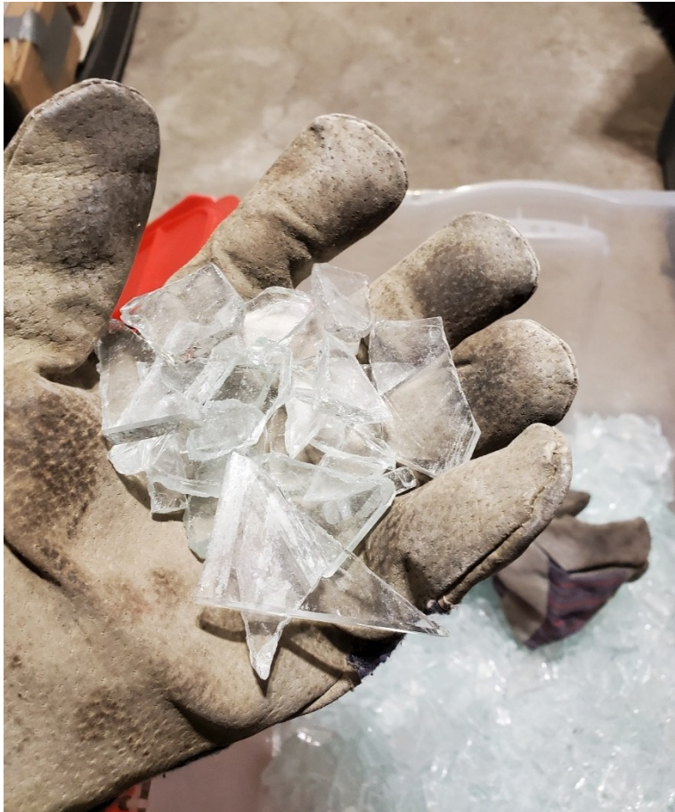
Figure 5.4 Verre transparent provenant d'un luminaire défectueux
