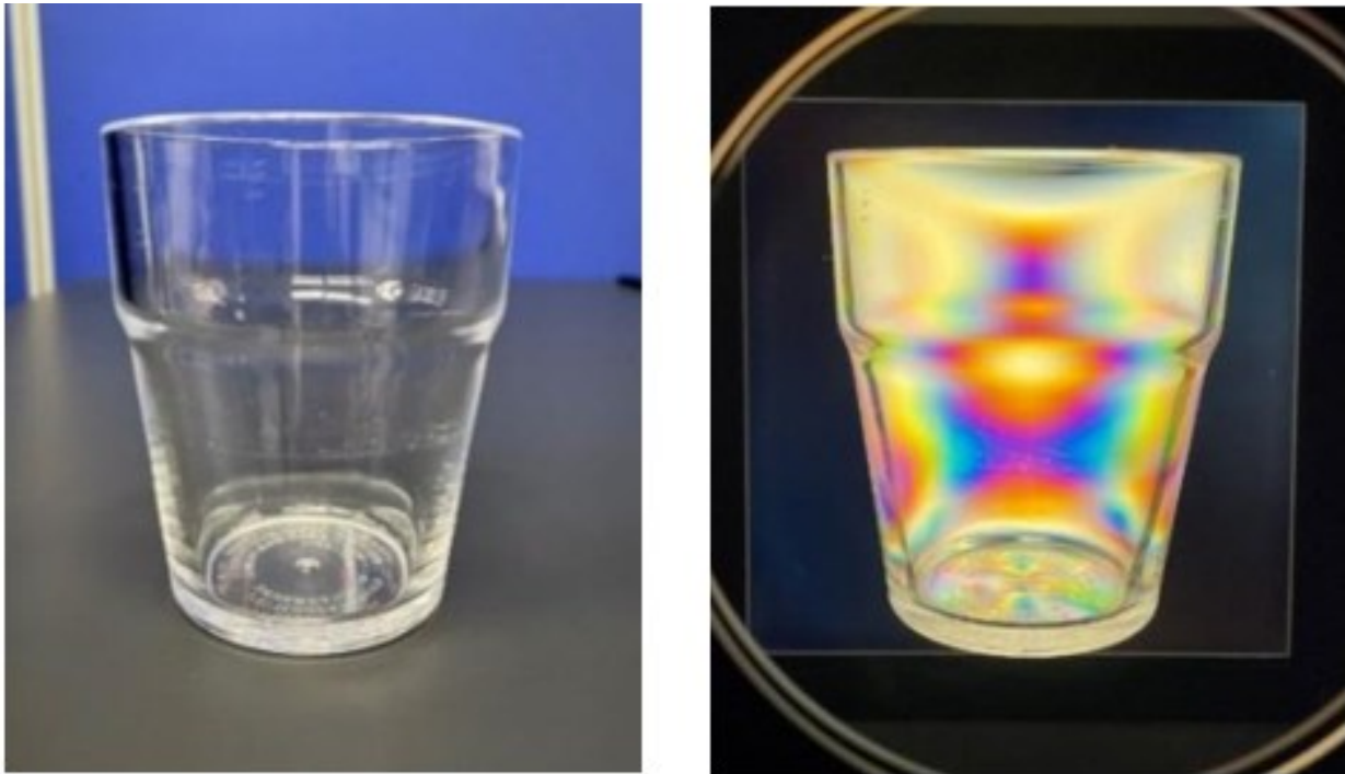
Figure 3.3 Observation des contraintes internes d'un verre au polariscope
