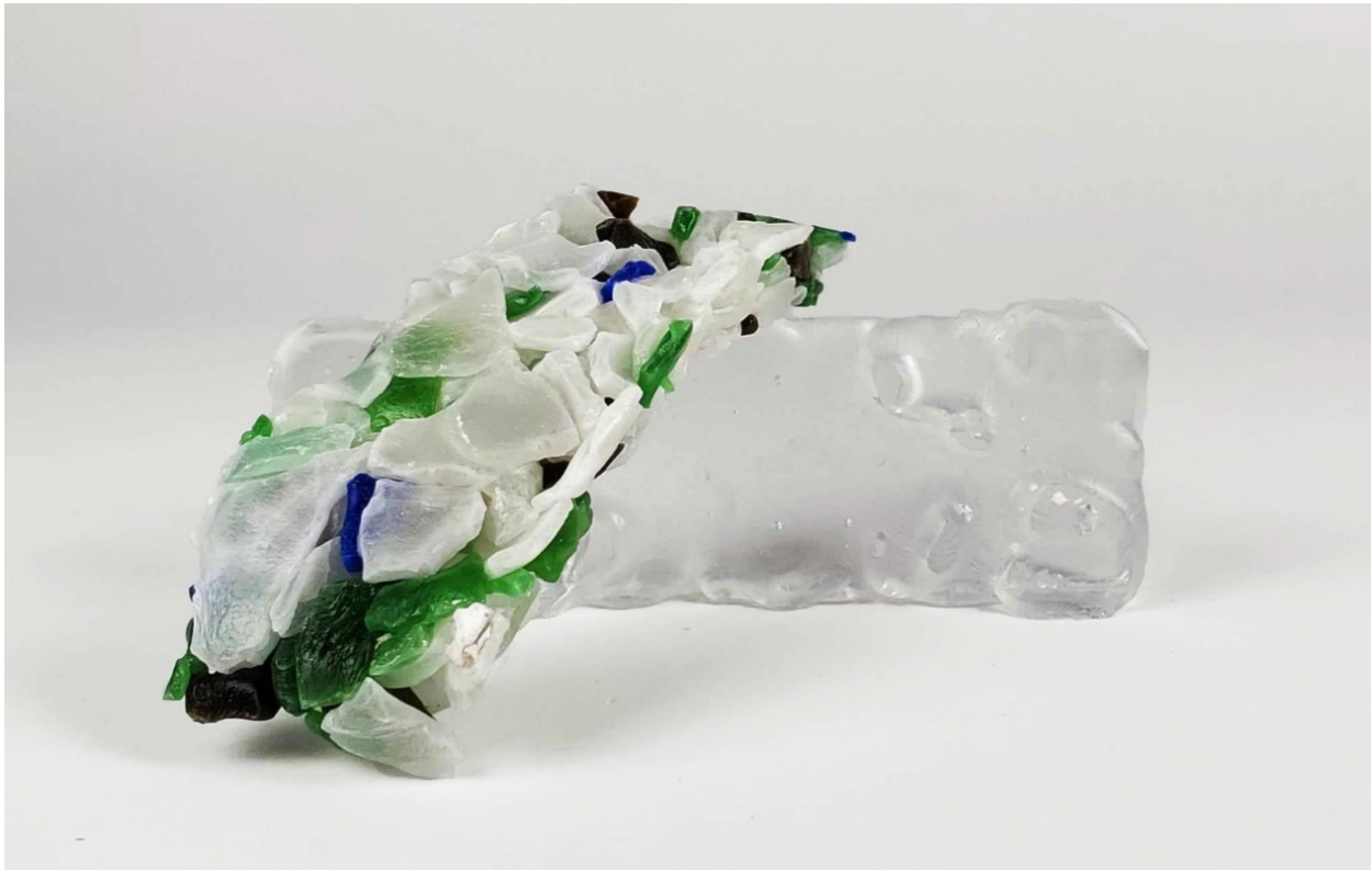
Figure 3.4 Verre dévitrifié versus verre fusionné
