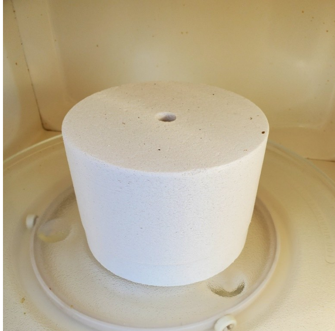
Figure 5.8 Test de fusion du verre dans un four à micro-ondes avec moule réfractaire
