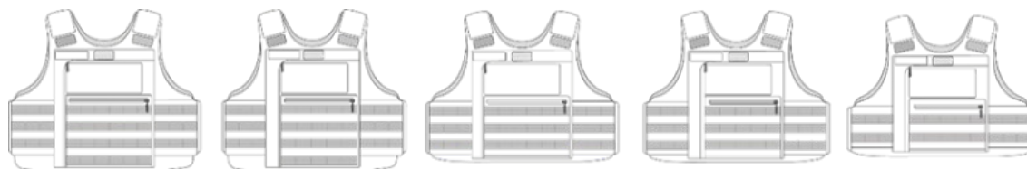
Figure 18 : Variation des rangées et des colonnes du système MOLLE en fonction des morphologies
