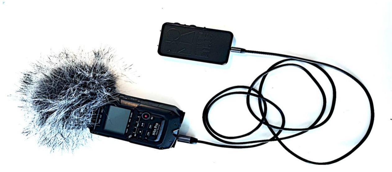
Figure 2.17 : Dispositif portable de captation électromagnétique, ©FIZA 2025
