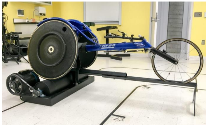
Figure 3.7 : Ergomètre à rouleau pour fauteuil de course du Laboratoire de recherche Mobilité & Sport Adapté
