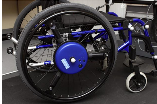
Figure 1.7 : SMARTWheel installée sur un fauteuil standard (Gil-Agudo et al. , 2010) et reproduite avec l'autorisation de Elsevier
