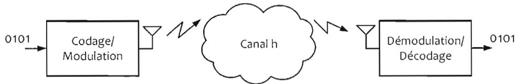
FIG. 1.2: Diagramme d'un système de transmission sans fil SISO
