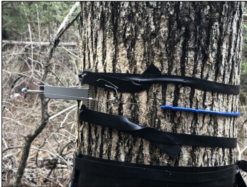
Figure 3.3.1 : Exemple d'installation d'un Type DC3 Circumference Dendrometer dans la placette STE1 sur un frêne noir.
