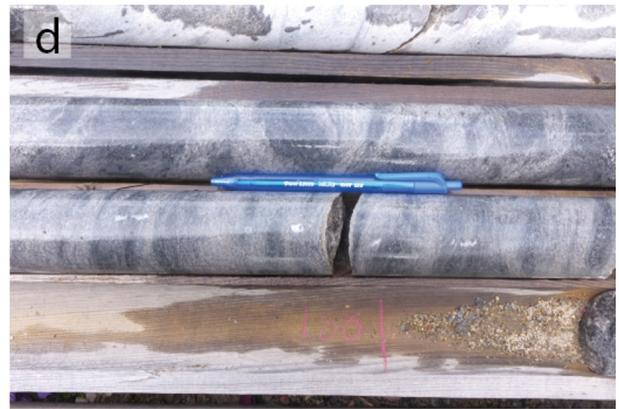
**Figure 9 :** Carotte provenant du forage HEN-317 au gîte d'Izok Lake : **a)** brèche rhyolitique; **b)** tuf rhyolitique à lapilli, d'origine volcanoclastique, finement lité et très feuilleté; **c)** rhyolite silicifiée à texture mylonitique; **d)** rhyolite à texture pseudo-clastique ou en « agrégats de chlorite ».
