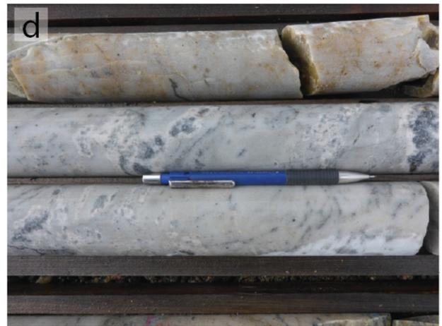
**Figure 7 :** Carotte provenant du forage HEN-228 au gîte d'Izok Lake : **a)** leucogranite blanc et tuf dacitique; **b)** porphyroblastes à noyau de mica blanc bordés de chlorite et de feldspath blanc; **c)** texture pseudo-clastique ou en « agrégats de chlorite » dans une rhyolite séricitisée; **d)** rhyolite séricitisée et lessivée.
