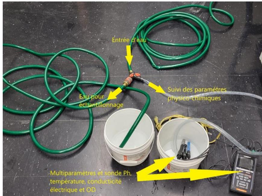
**Figure 9 : Schéma d'échantillonnage de l'eau souterraine**
