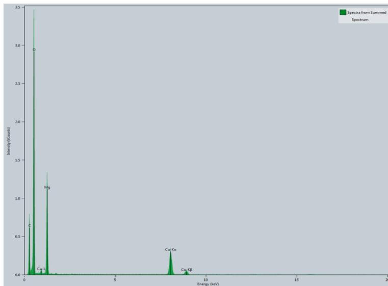
Figure 4.1 Composition chimique des nanofils de MgO synthétisés par Spectromètre à Dispersion d'Énergie
