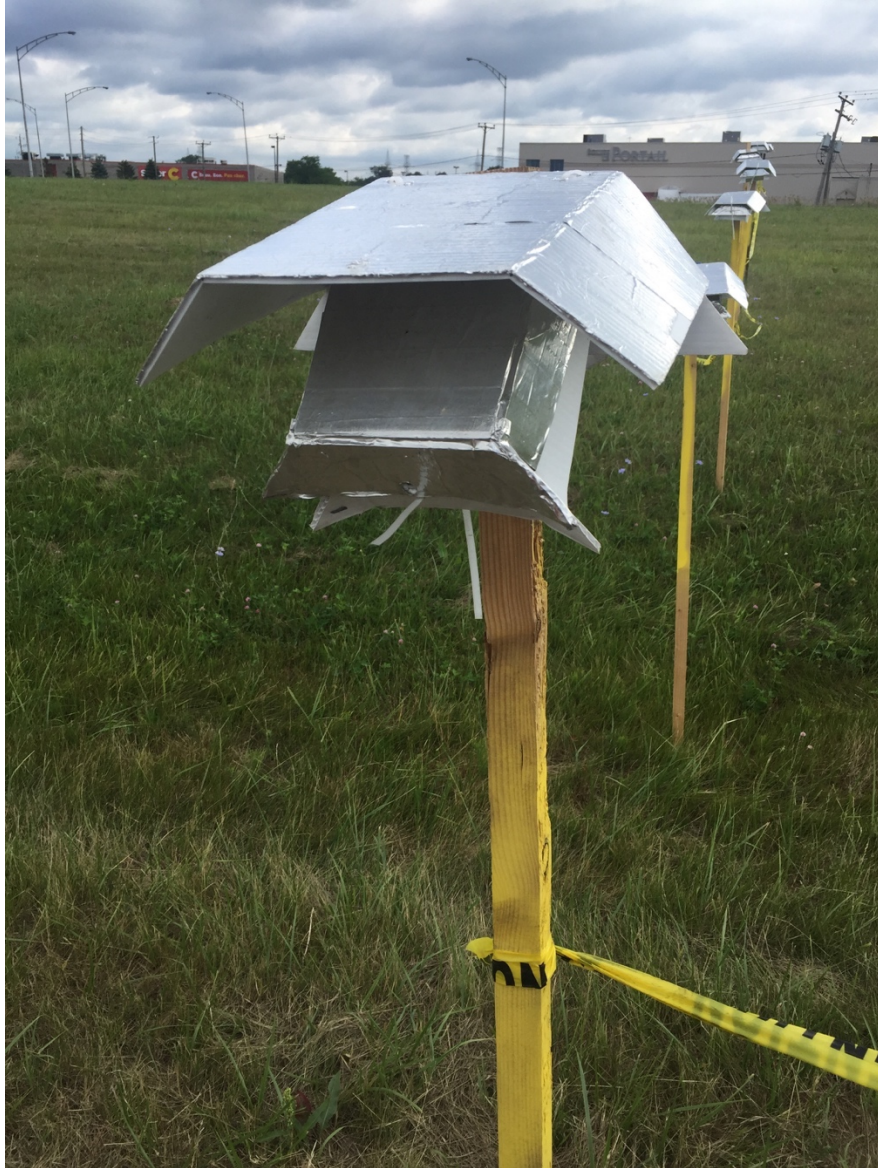
Figure A.2: Image du bouclier thermique en coroplaste recouvert d'adhésif à conduit de ventilation qui protège la sonde des radiations solaires et aide à la circulation d'air autour de celle-ci. La sonde est placée à l'intérieur du réceptacle qui pend sous le bouclier supérieur.
