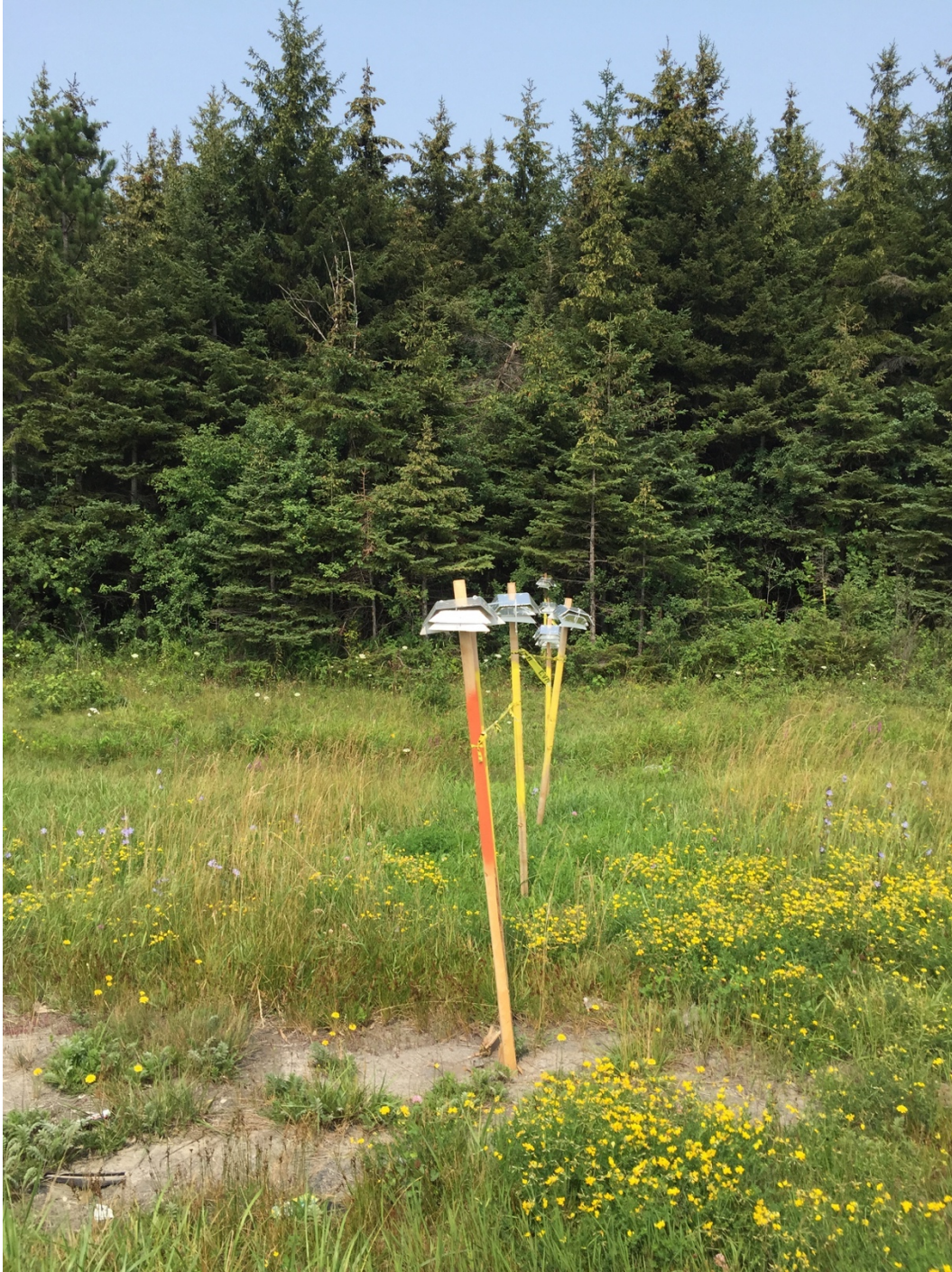
Figure A.4 : Image de la disposition des sondes le long du transect. Les sondes étaient installées en ligne la plus droite possible. L'angle des tuteurs n'était pas toujours à 90° avec le sol puisque la dureté du sol pouvait rendre l'installation plus difficile.
