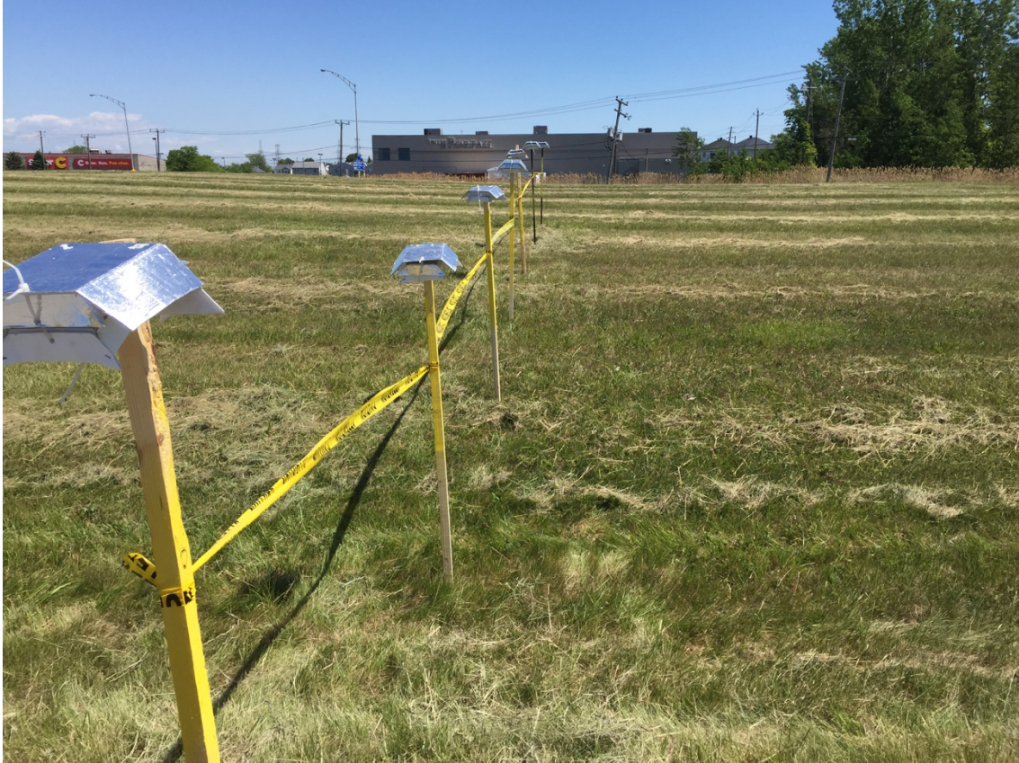
Figure A.1 : Image du dispositif dans une bretelle d'autoroute recouverte uniquement de gazon. Les sondes sont perpendiculaires avec la route et vont vers le centre de la bretelle.
