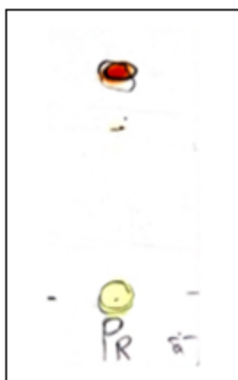
Figure 2.7 Plaque CCM de produit obtenu après la synthèse de la sonde SF4 avec un éluant (1:1 Hex: EtOAc).
