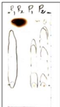
Figure 2.3 Analyse CCM des produits de la réaction du 1,3-aminophénol et de l'anhydride trimellitique : Comparaison des produits obtenus de l'expérience 1 (P1) et de l'expérience 2 (P2) avec éluant 5:2 (EtOAc/MeOH) (tableau 2.1).
