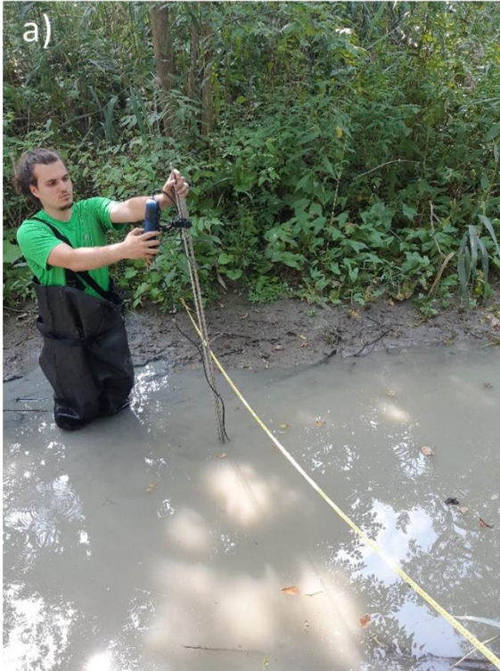
Figure 13 Mesures des débits avec a) le vélocimètre électromagnétique Hach FH950 et b) le profileur acoustique StreamPro ADCP
