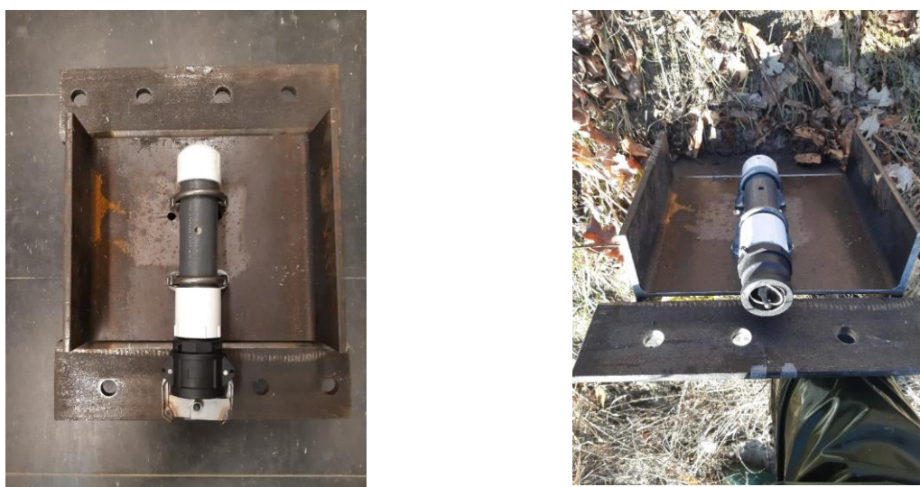
Figure 11 Dispositif contenant la sonde pour la station de niveau d'eau à la station Rigaud Sud
