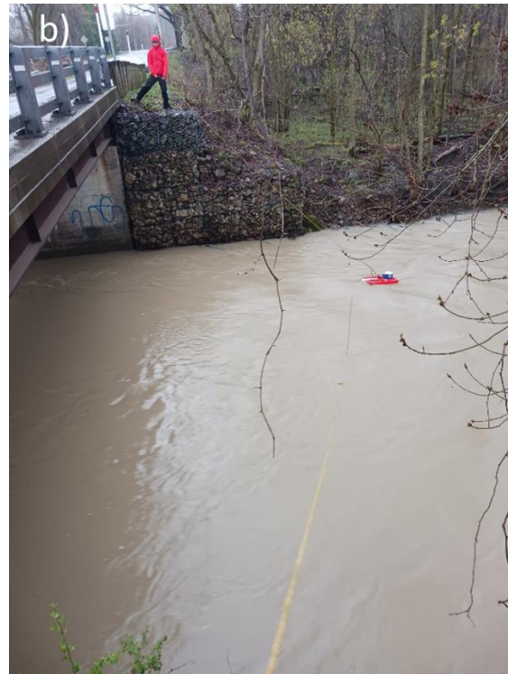
Figure 13 Mesures des débits avec a) le vélocimètre électromagnétique Hach FH950 et b) le profileur acoustique StreamPro ADCP
