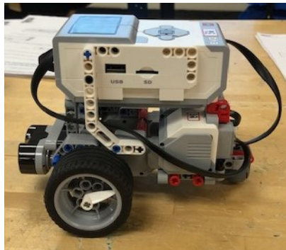
Figure 4.4 — Le laboratoire de robotique MRUA — Photo du robot Lego Mindstorm (EV3) utilisé pour l'activité
