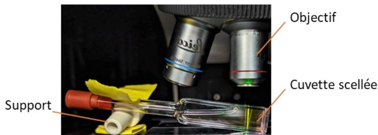
Figure 2.5. Montage utilisé pour l'obtention d'un spectre de résonance Raman *in situ* en solution.
