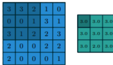
Figure 2.7: Exemple de maxpooling (Dumoulin et Visin, 2016)
