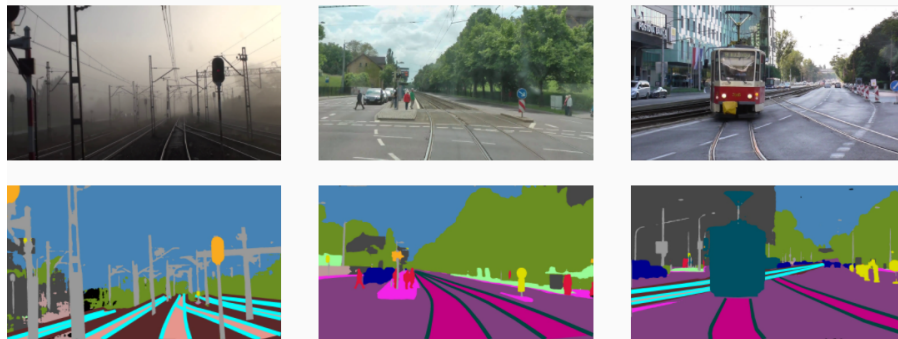
Figure 4.6: Exemples d'images dans Railsem19, accompagnées de figures d'annotations sémantiques
