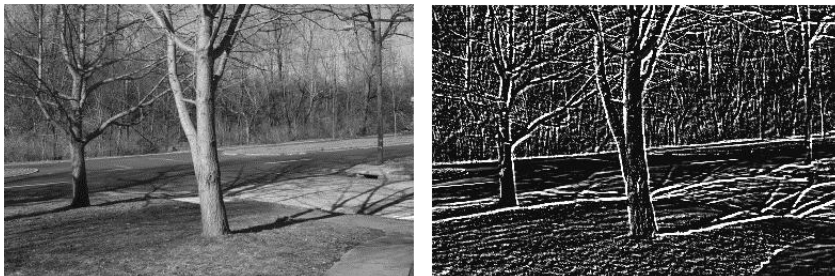
Figure 2.3: Détection de contours (Sinha, 2022)
