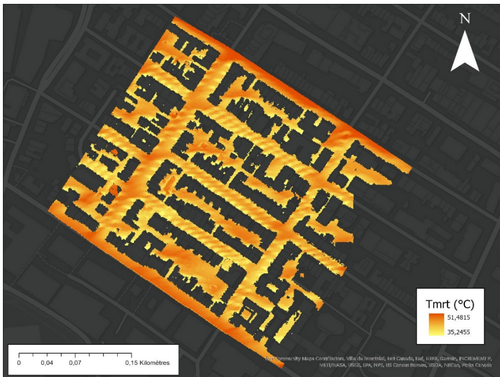
Figure 3.12 Carte de T_{mrt} moyenne des heures diurnes avec l'ensemble des arbres fictifs de la zone du Plateau Mont-Royal
