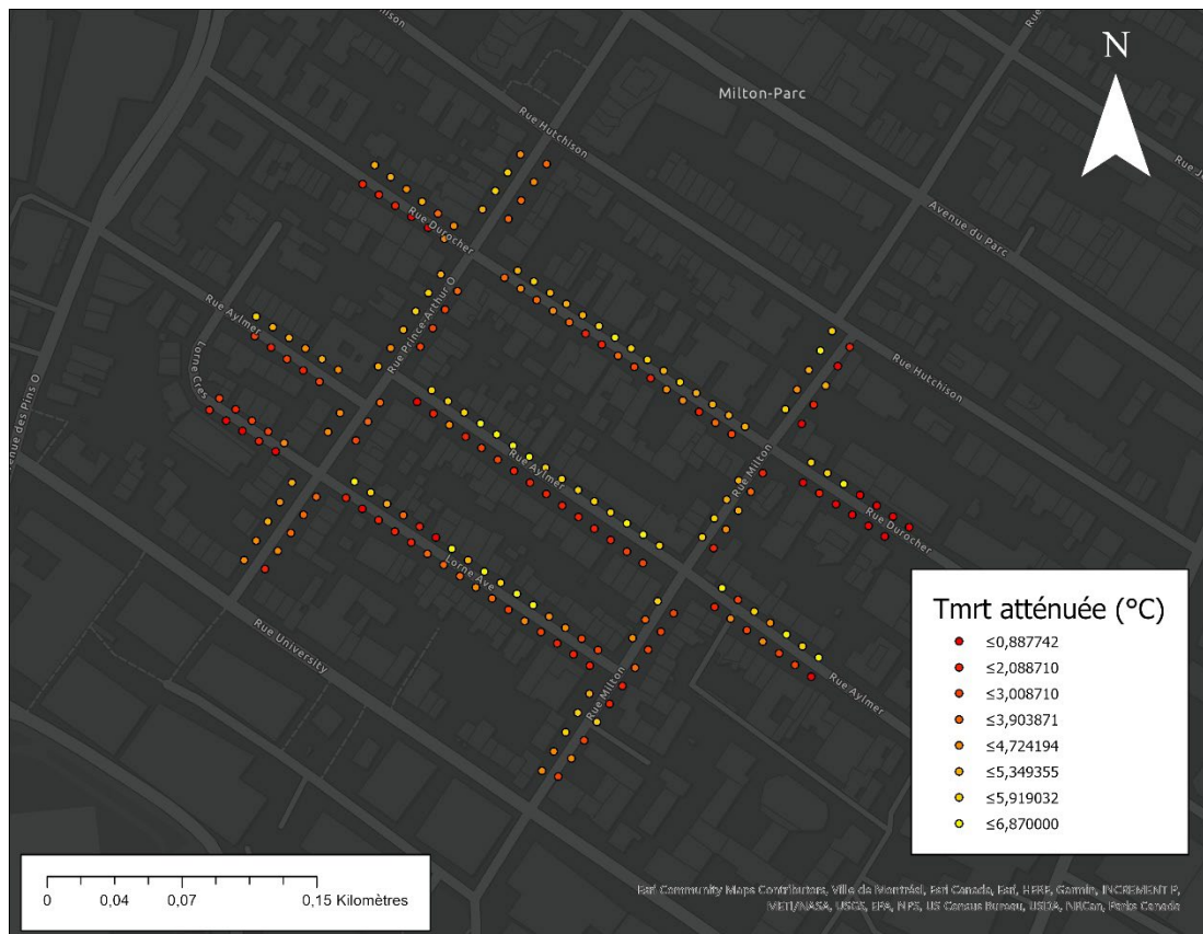
Figure 3.17 Carte de T_{mrt} atténuée moyenne quotidienne pour chacun des POIs de la zone du Plateau Mont-Royal
