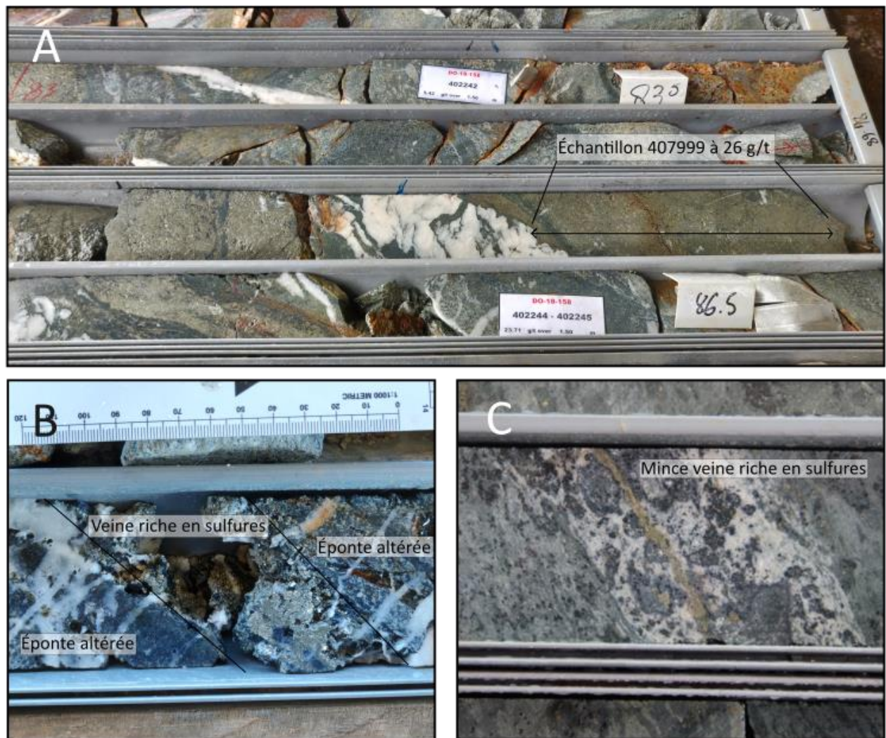
Figure 32 : Photographie des veines de quartz-tourmaline riches en sulfures A) Veine de quartz-tourmaline avec sulfures massifs dans le forage DO-18-158. Cet échantillon présente une teneur en or de 26g/t; B) Veine de quartz-tourmaline riche en sulfures avec épontes altérées dans le forage DO-18-173; C) Mince veine de pyrite avec épontes de roches volcanoclastiques tourmalinisées et silicifiées dans le forage DO-18-179 recoupée par une mince veine de sulfures.
