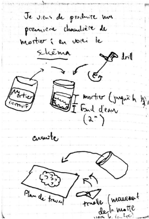
Figure 2.1 Recette de mortier
