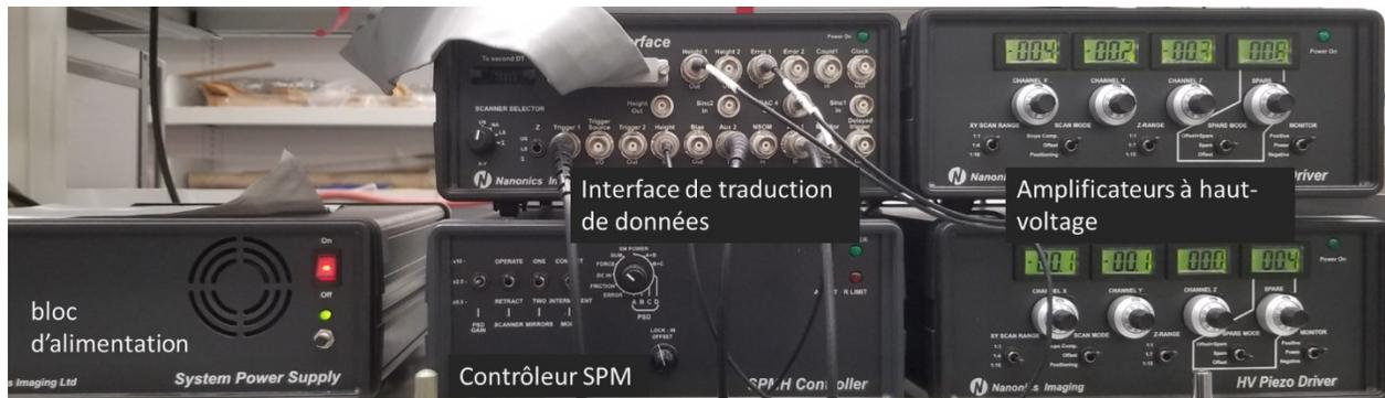
Figure 30. Modules composant le microscope AFM MV2000, excluant la tête AFM et l'ordinateur secondaire.
