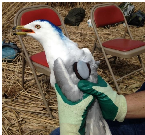
Figure 0.5 Échantillonneur passif d'air apposé à l'aide d'un harnais au milieu du dos d'un goéland à bec cerclé.
