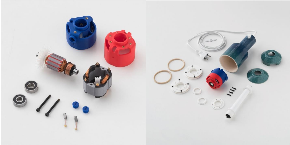
Figure 1.8 (à gauche) Moteur universel standard , Nicolas Hervé, 2020
